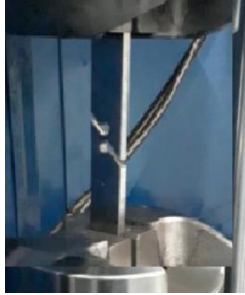
Figura 2 – Controle de deslocamento para o ensaio em CP de cisalhamento
