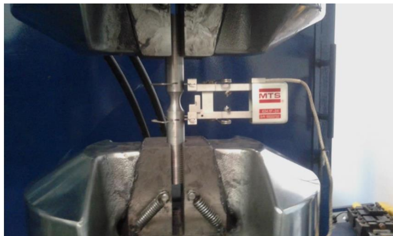
Figura 1 - Controle de deformação para os ensaios monotônicos em CP's cilíndricos com extensômetro de 25 mm de comprimento útil
