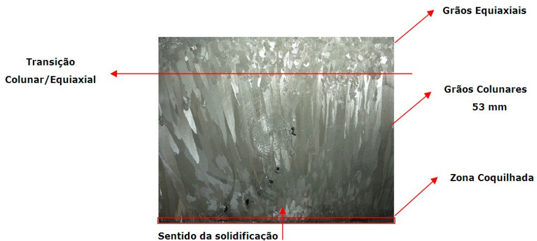
Figura 44 - Análise da macroestrutura de solidificação após ataque químico da liga Al0,4%Nb.
