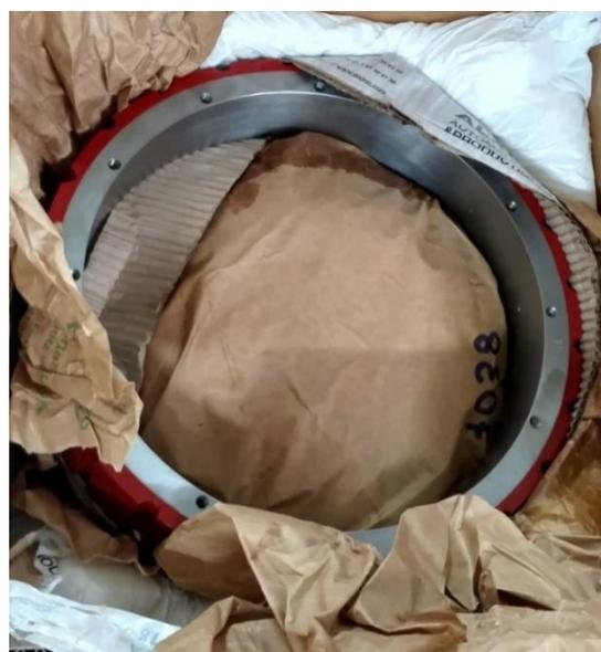
Figura 16 – Rotor do PMSG.
