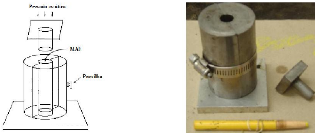
Figura 2-1. Molde de Compactação (Coutinho, 2012)
