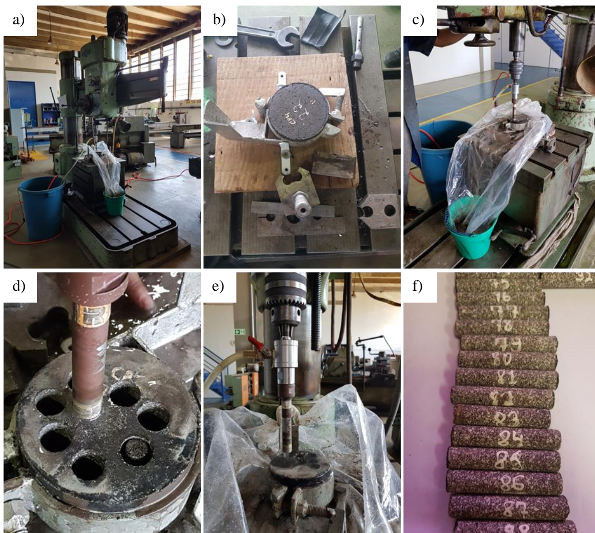
Figura 4-4. Processo de Extração dos Mini CP's: (a) Furadeira utilizada no processo; b) Fixação do CP Marshall; c) Proteção da Furadeira e coleta de água utilizada; d) Mini CP's já extraídos e preparação para outra extração; e) Detalhe do sistema Furadeira, Adaptador, Broca e proteção; f) Mini CP's identificados após extração
