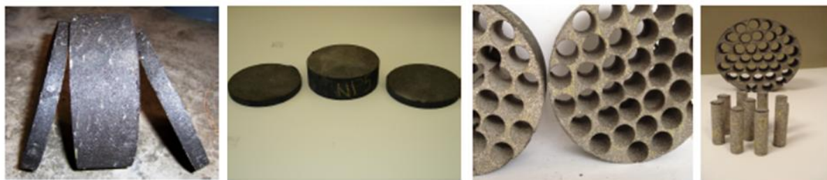
Figura 2-2. CPs Cilíndrico serrado topo e base e amostras extraídas com a serra copo (Castelo Branco, 2008)
