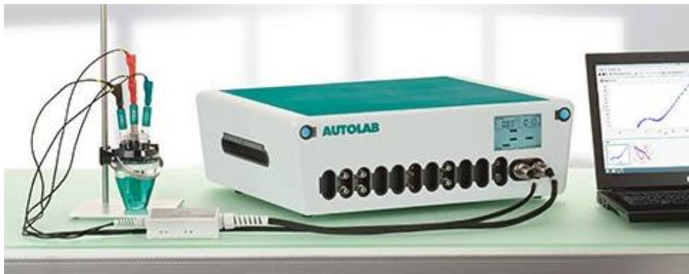
Figura 41: Conjunto, potenciostato e célula de 3 eletrodos.
