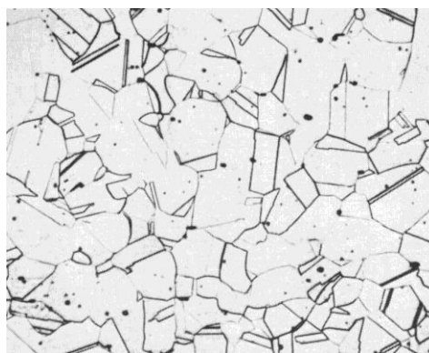
Figura 2: Exemplo de microestrutura austenitica (ASM HANDBOOK,2005)
