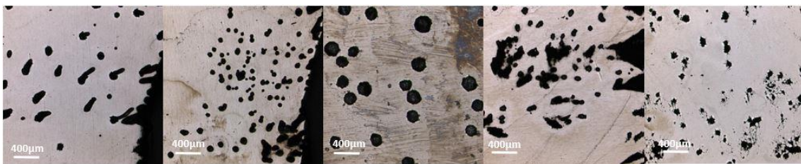
Figura 72: Detalhe da corrosão nas amostra da região de adição, aumento de 50x
