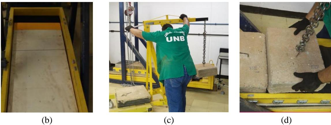
Figura 3.16. Fixação das amostras e colocação da tensão normal. (a) Esquema com secção da rampa mostrando a ancoragem do geotêxtil; (b) Foto da ancoragem do geotêxtil; (c) Transporte dos blocos; (d) Colocação dos blocos na sua posição na caixa.
