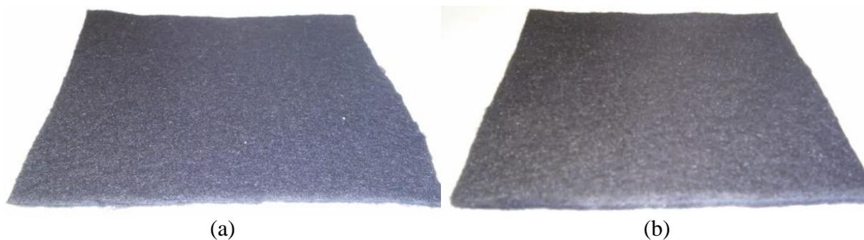
Figura 3.4. Geotêxteis não tecidos agulhados: (a) GNT1, (b) GNT2.
