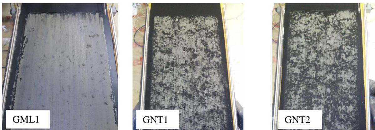
Figura 4.22. Geossintéticos após ruptura para os ensaios com abatimento de 80 mm.
