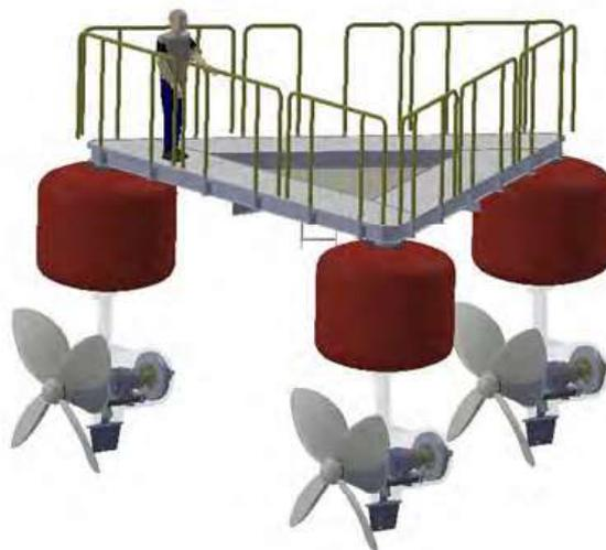
Figura 11 – Arranjo modular flutuante de turbinas hidrocinéticas - projeto HydroK
