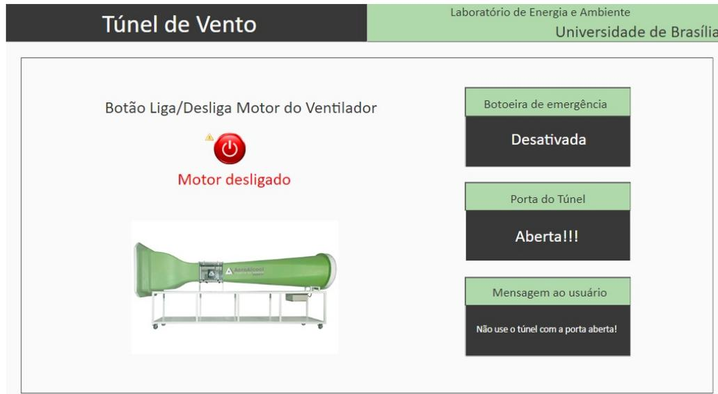
Figura 55 – IHM de acionamento do túnel de vento - ScadaBR.
