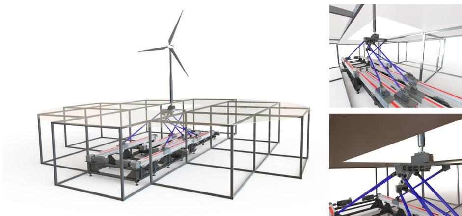
Figura 4 – Plataforma Robótica com 6 graus de liberdade para testes em túnel de vento de turbinas eólicas flutuantes. Fonte: Bayati et al. (2014).
