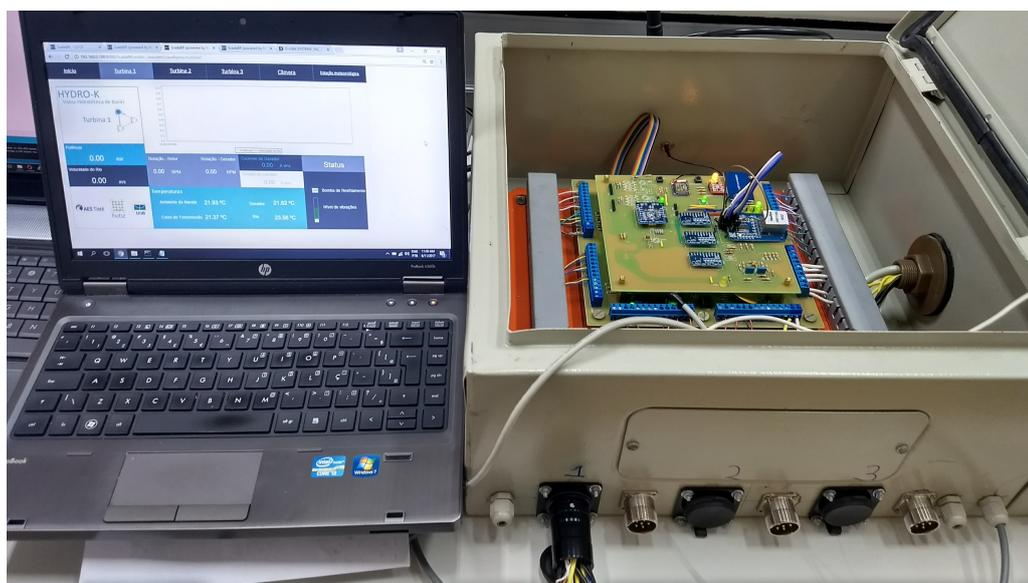
Figura 60 – Teste de comunicação entre o ScadaBR e a plataforma de instrumentação.
