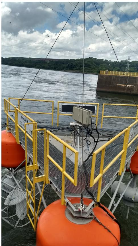
Figura 65 – Caixas 1 e 2 de instrumentação fixadas na plataforma.
