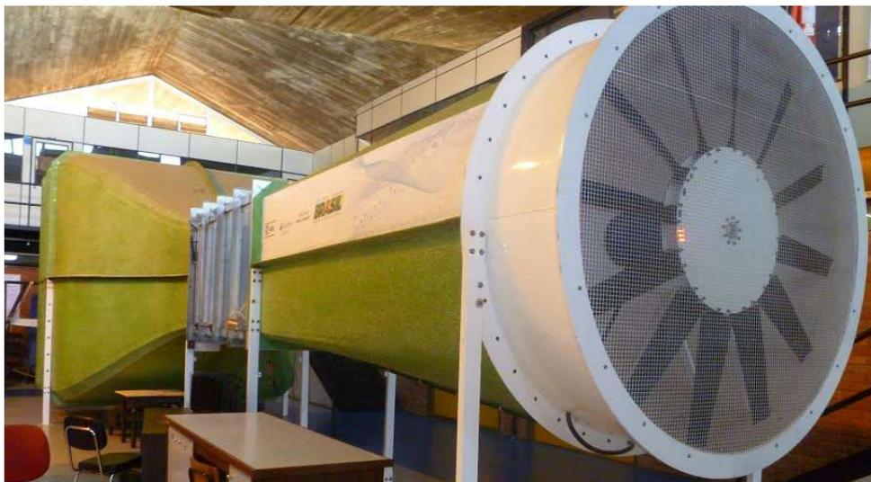
Figura 54 – Ventilador do túnel de vento.
