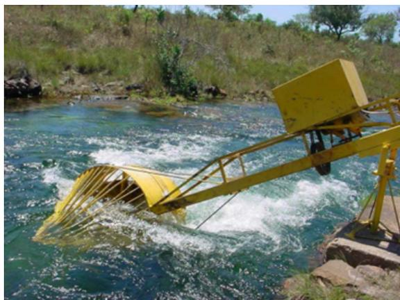
Figura 8 – Turbina de Geração 1 instalada em Correntina-BA (1991)
