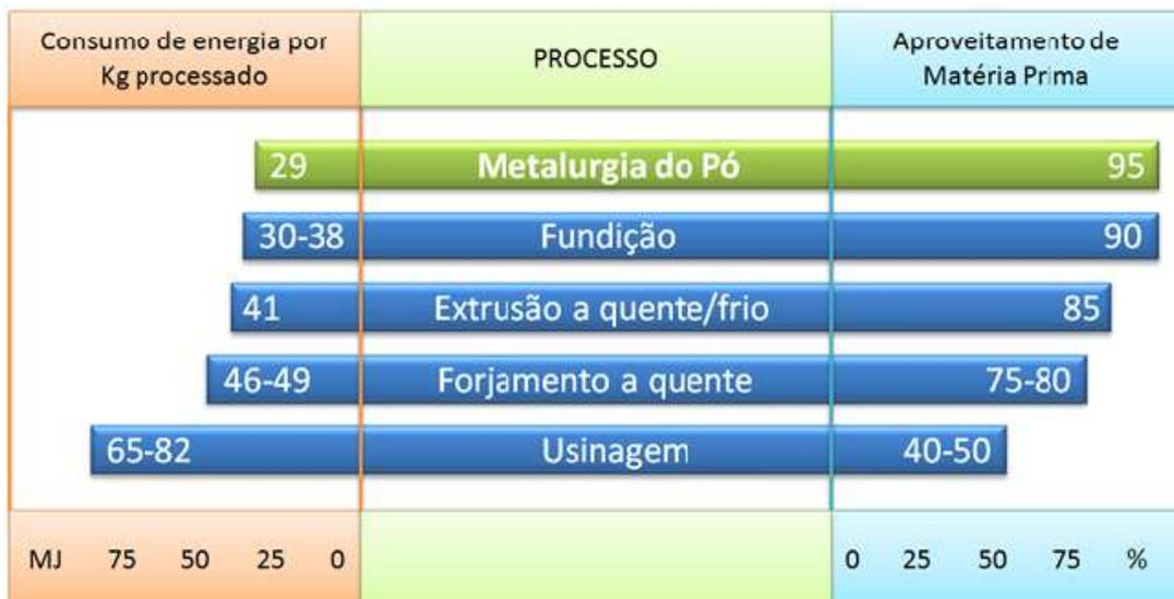
Figura 3 – Vantagens da metalurgia do pó sobre outros processos (Grupo setorial de metalurgia do pó, 2017).
