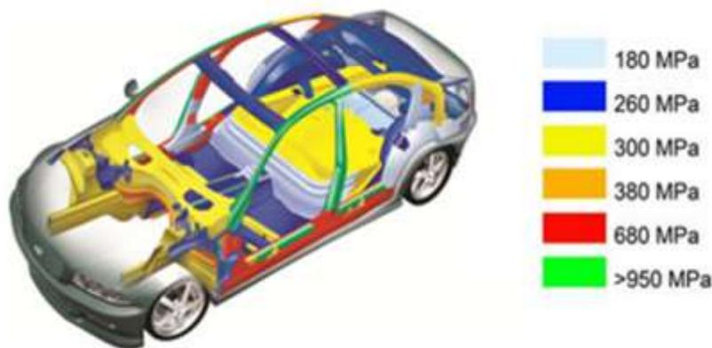
Figura 1 - Ilustração gráfica de diferentes tipos de aço com nióbio, utilizados em um veículo de passageiros, as cores refletem a resistência do aço em unidades de megapascal (CBMM, 2017).
