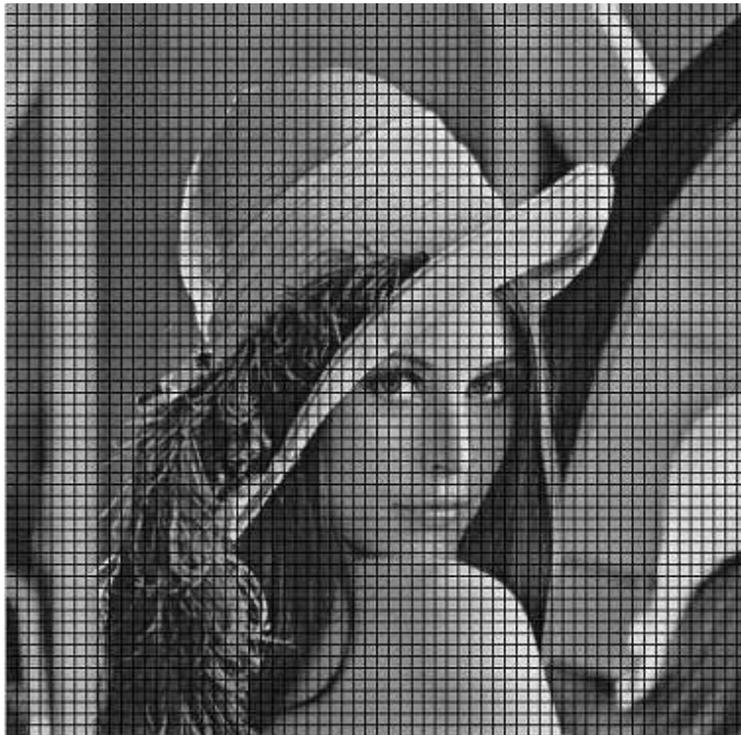
Figura 2.2: Imagem dividida em blocos de  $8 \times 8$  pixels.
