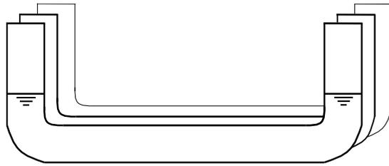
Figura 3.16 - Múltiplos atenuadores de coluna líquida
