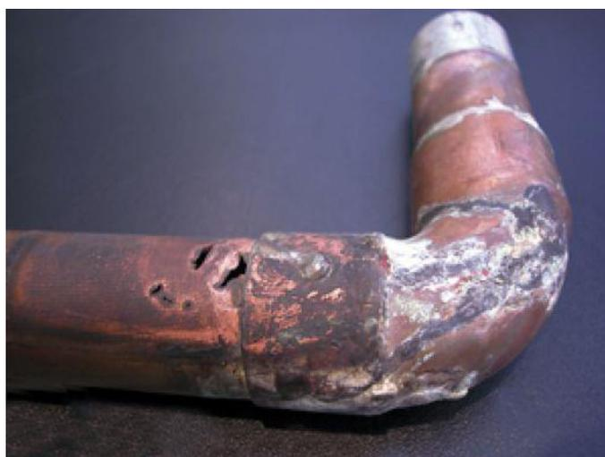
Figura 1.1.1: Corrosão em duto metálico <sup>3</sup>.
