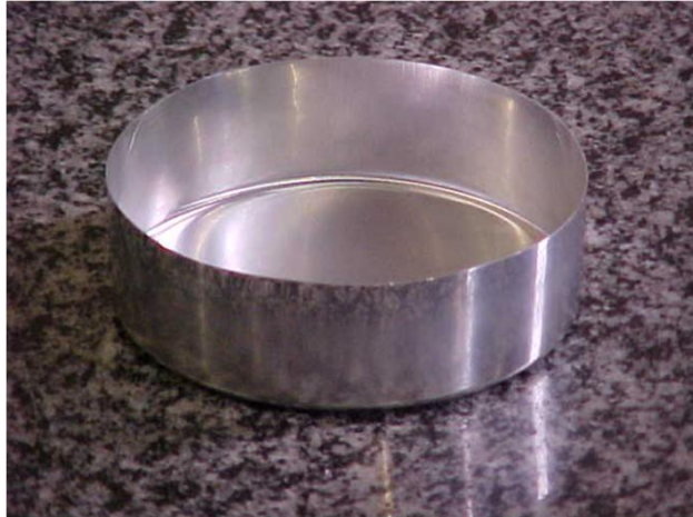
Figura 2Copo formado pelo corte na bobina metálica
