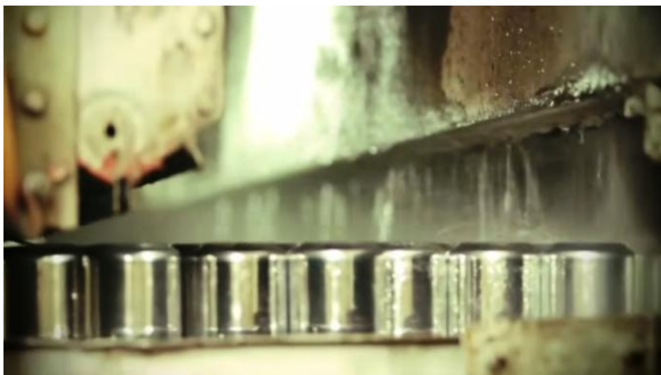
Figura 4 Lavadora de latas, imagem interna do equipamento 19
