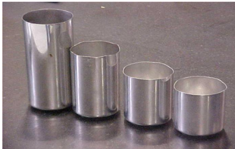
Figura 3 Processo de estiramento para formação da lata de alumínio 19
