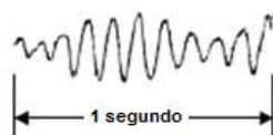
Figura 2.4 - Representação da frequência de Strouhal = 23,5 Hz em um cabo DRAKE sob a ação de um vento de 3,58 m/s (Irvine, 2006, modificado).
