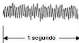
Figura 2.5 - Representação da frequência de Strouhal = 72,4 Hz em um cabo blindado sob a ação de um vento de 3,58 m/s (Irvine, 2006, modificado).
