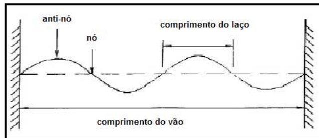
Figura 2.7 - Representação do laço das vibrações de uma onda estacionária 6 (Kasap, 2012, modificado).
