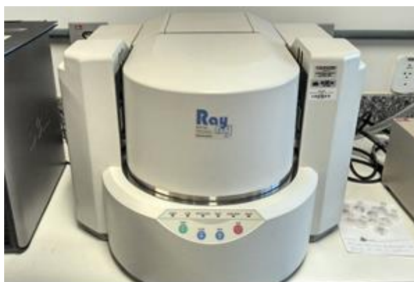
Figura 3.9 – Espectrômetro de Fluorescência de Raios X por Energia Dispersiva da central analítica (IQ/UnB)
