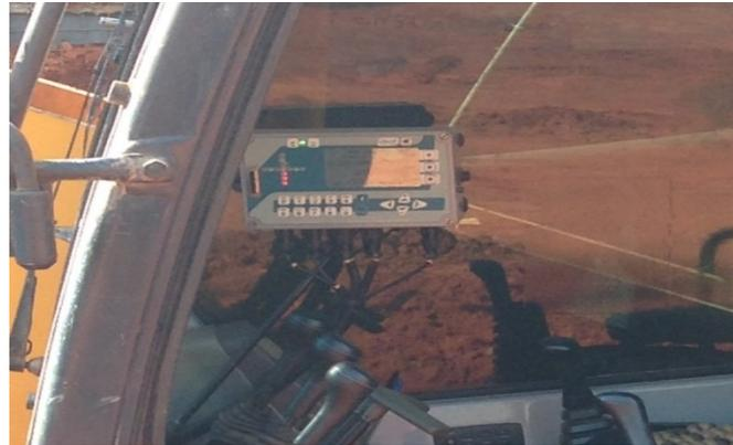
**Figura 2.7** – Computador instalado na cabine do operador, sistema SACI
