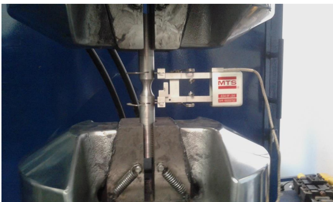
Figura 4.5 – Exemplo de montagem dos corpos de prova na máquina de ensaio, com o clip gage instalado.
