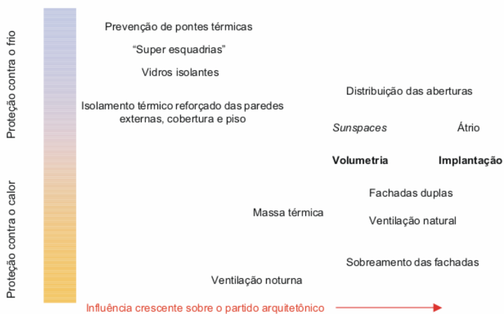
Figura 3.3 Táticas de condicionamento térmico passivo observadas em experiências recentes de arquitetura orientada para a eficiência energética, em países europeus selecionados, de clima temperado ou frio.
