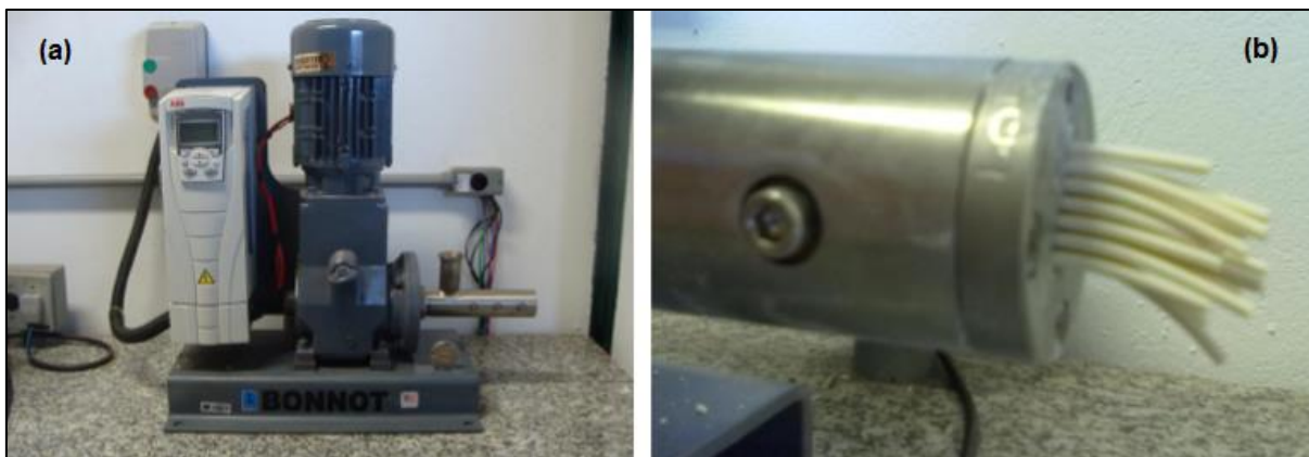
Figura 20 – (a) Extrusora para obtenção dos pellets do catalisador, (b) Extrusão da pasta do catalisador utilizando molde de 2 mm de diâmetro
