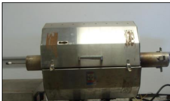
Figura 18 – Forno tubular utilizado para calcinar os sólidos finos do precursor catalítico.
