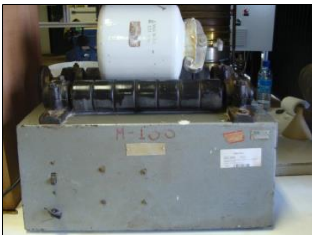
Figura 16 – Moinho de bolas, constituído por jarro de cerâmica de 2,5 L, esferas e rolete (esteira).
