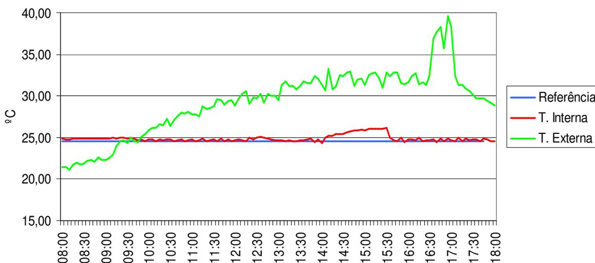
Figura 6.13 - Temperatura na Sala Desenvolvimento - Controle Fuzzy 14-09-2006
