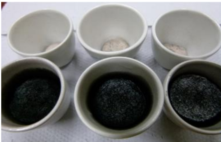
Figura 6 - Imagem dos cadinhos antes e após a análise imediata.
