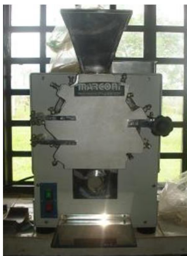
Figura 4 - Moinho de faca utilizado para moagem das biomassas residuais
