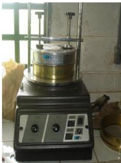
Figura 5 – Classificador utilizado para separar biomassas moidas.
