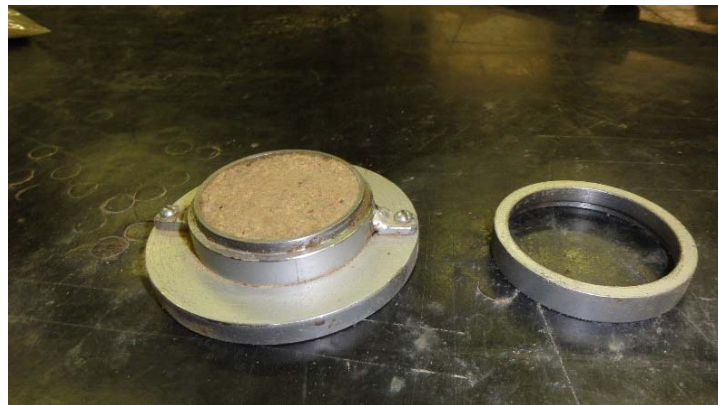
Figura 3. 11 - Molde metálico usado para compactação das amostras
