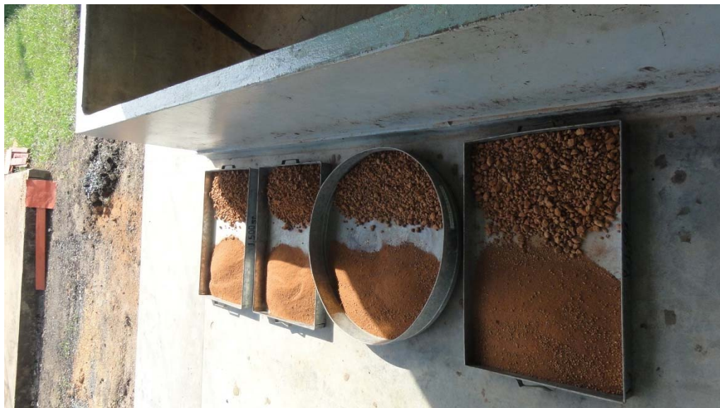
Figura 3. 9 - Preparação dos amostras - ensaio de compressão simples
