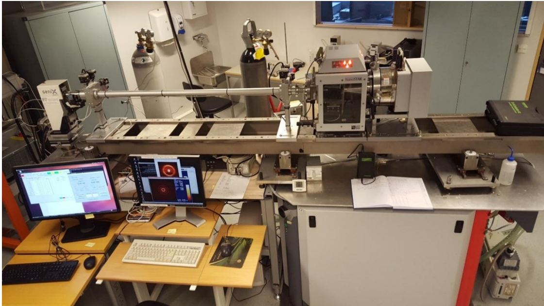
Figura 3.5: Equipamento de espalhamento de raios X NanoSTAR, da Bruker AXS, ligado a uma fonte de impacto de elétrons estacionário Xenocs com anodo de cobre.
