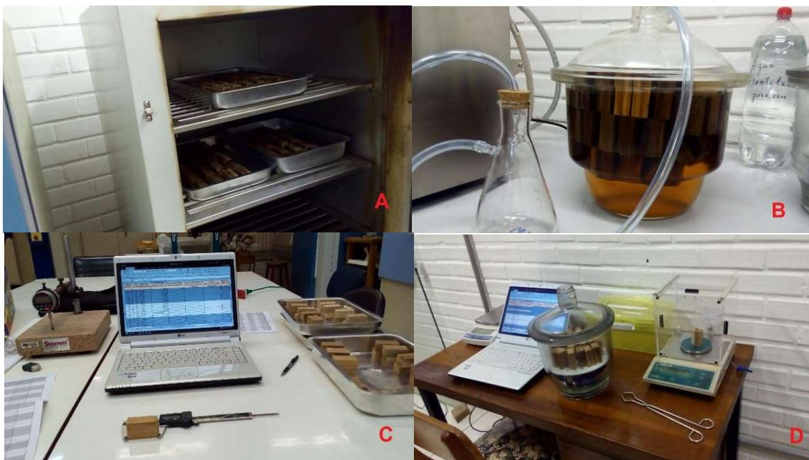
Figura 2.5 – Ensaio das propriedades físicas da madeira de seis procedências de *Tectona grandis*, com nove anos de idade: secagem da madeira (A); saturação dos corpos de prova em água (B); medidas das dimensões com paquímetro (C); e mensuração da massa em balança analítica (D).
