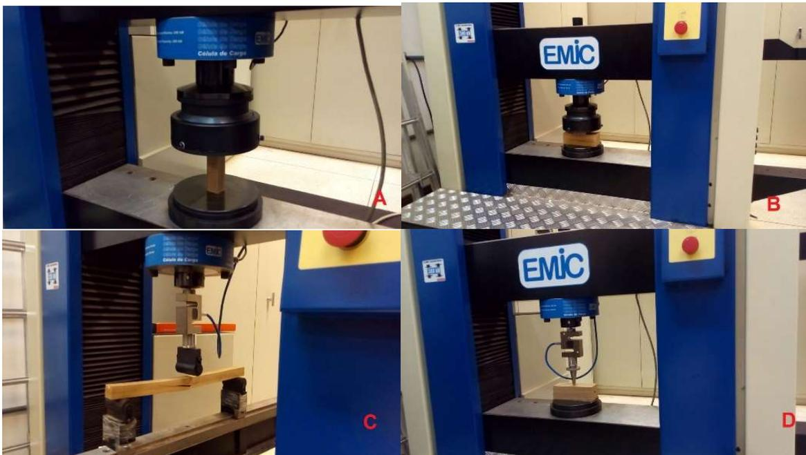
Figura 2.6 – Ensaio mecânicos da madeira das seis procedências de *Tectona grandis*: resistência à compressão paralela às fibras (A); resistência à compressão normal às fibras (B); flexão estática (C); e dureza Janka (D).
