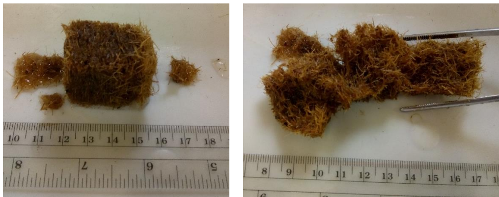
Figura 25 - Corpos de prova do tratamento AC 0% após ensaio de imersão em água por 24 horas.
