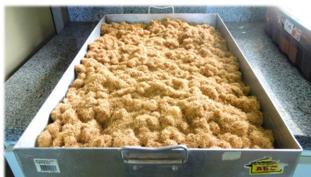
Figura 7 - Fibras tratadas, após aspersão de AC e acondicionamento em estufa.
