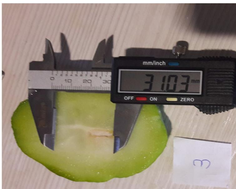
**Figura 70** – No experimento 3 também não ocorreu o Roll-off. A constatação é perceptível pelo não surgimento de linhas escuras na região de queima. O Diâmetro de queima foi de 3,1 cm. Fonte: própria.
