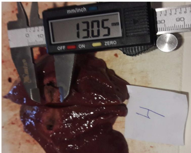
**Figura 76** – No experimento 4 notou-se cavidades no centro da região de ablação. A potência utilizada foi de  $30W_{RMS}$  e o ângulo do eletrodo manteve-se igual aos outros experimentos. O diâmetro da região de queima foi de 1,31 cm. Fonte: própria.
