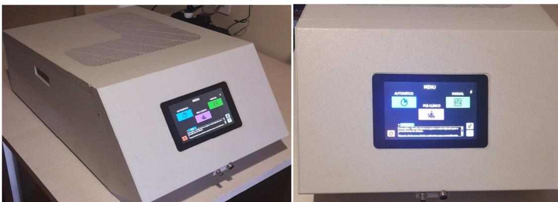
**Figura 78** – Esta é a imagem do Equipamento médico assistencial. Nesta versão existem dois conectores consecutivamente para saída de RF e leitura de temperatura. Um novo case está sendo desenvolvido com mudanças relativas a esta versão.
