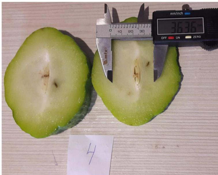
**Figura 71** – No experimento 4 ocorreu o *Roll-off*. O fato é constatado pelos surgimentos de pontos escuros que indicam carbonização do tecido do chuchu. O diâmetro de queima foi de 3,64 cm. Fonte: própria.
