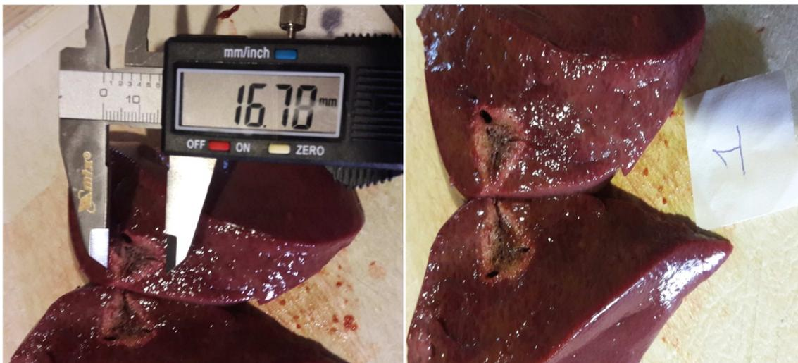
**Figura 73** – Nesta figura é possível notar os pontos de carbonização, que são as regiões bem escuras. O diâmetro de queima foi de 1,67 cm. A potência utilizada foi  $30W_{RMS}$ . O fígado utilizado no experimento é suíno encontrado em supermercado. Fonte: própria.
