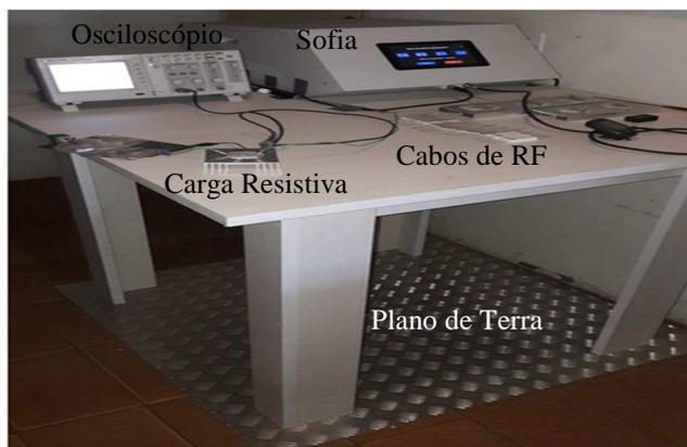
**Figura 33** - Esta bancada foi preparada atendendo os requisitos da norma NBR-IEC 60601-2-2. A mesa tem 1 m de altura, feita de madeira com uma placa de alumínio conectada ao neutro da tomada elétrica. Os cabos de AF e terra estão espaçados em 0,5m.
