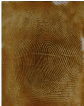
Figura 53. Imagem de impressão digital dopada com solução de MA  $1,0 \times 10^{-2}$  mol/L depositada sobre AgNPs/Agar/Al.
