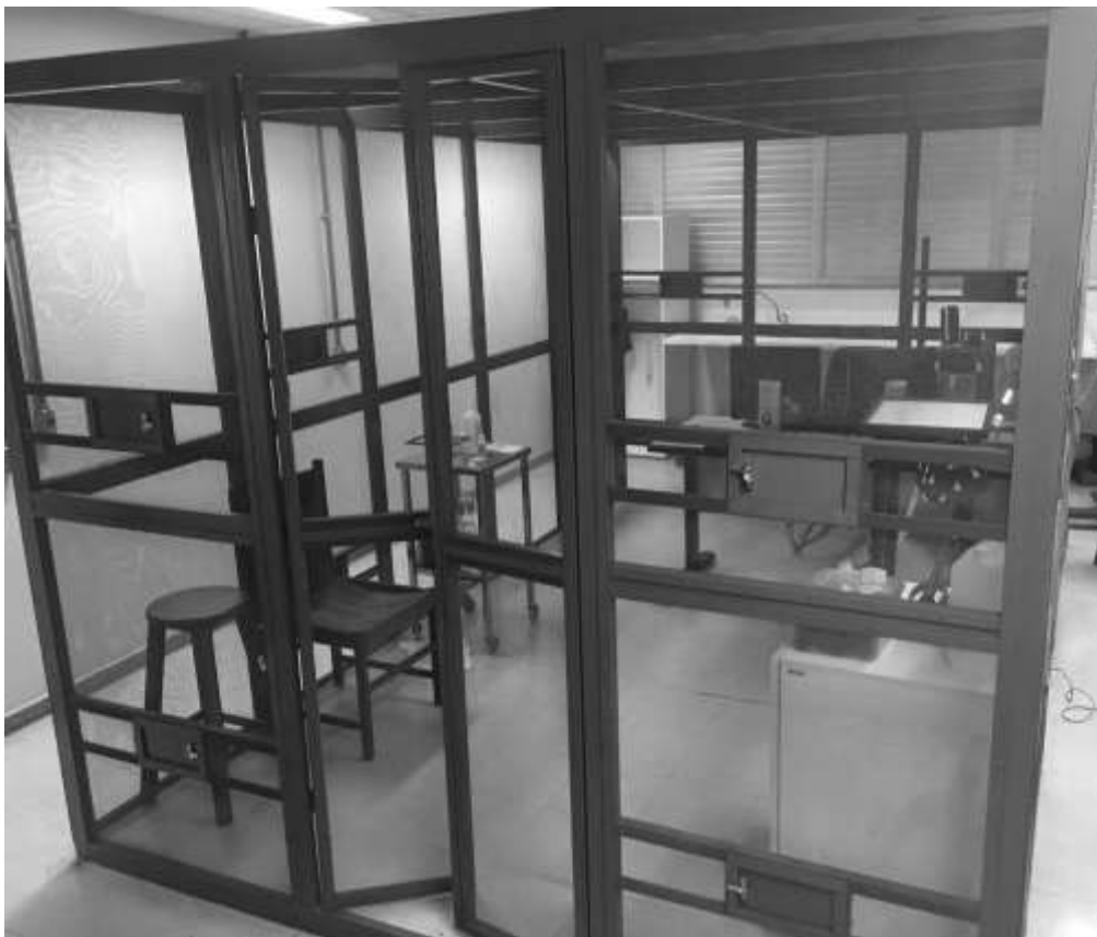
Figura 12. Gaiola de Faraday em que era realizada a aplicação do teste cognitivo e registro eletroencefalográfico (LxAxP: 259 x 223 x 396 cm).
