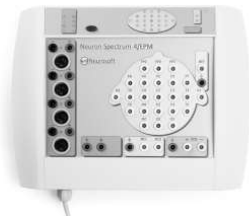
Figura 6. Aparelho pré-amplificador Neuron-Spectrum-4/EPM (NeuroSoft® ,Ivanovo/Rússia) utilizado para a coleta dos dados de EEG. Retirado de http://neurosoft.com/en/catalog/view/id/25 .
