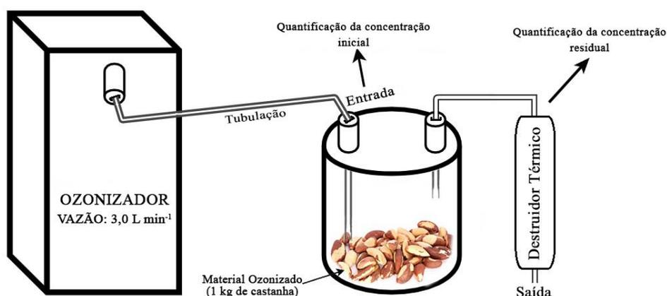
Figura 1. Esquema da ozonização de castanha-do-Brasil e quantificação da concentração residual do gás.
