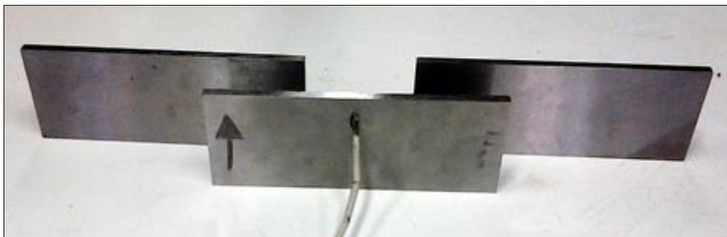
Figura 28 - Amostras cortadas de aço ASTM A743 CA6NM.
