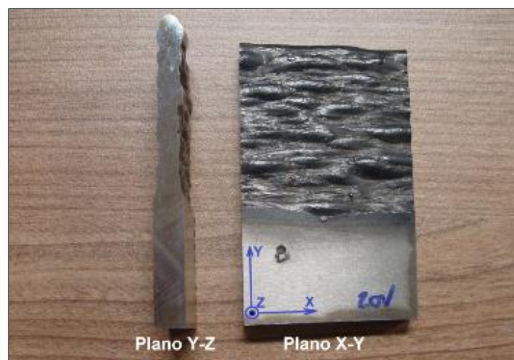
Figura 38 - Escolha da região a ser analisada microestruturalmente.
