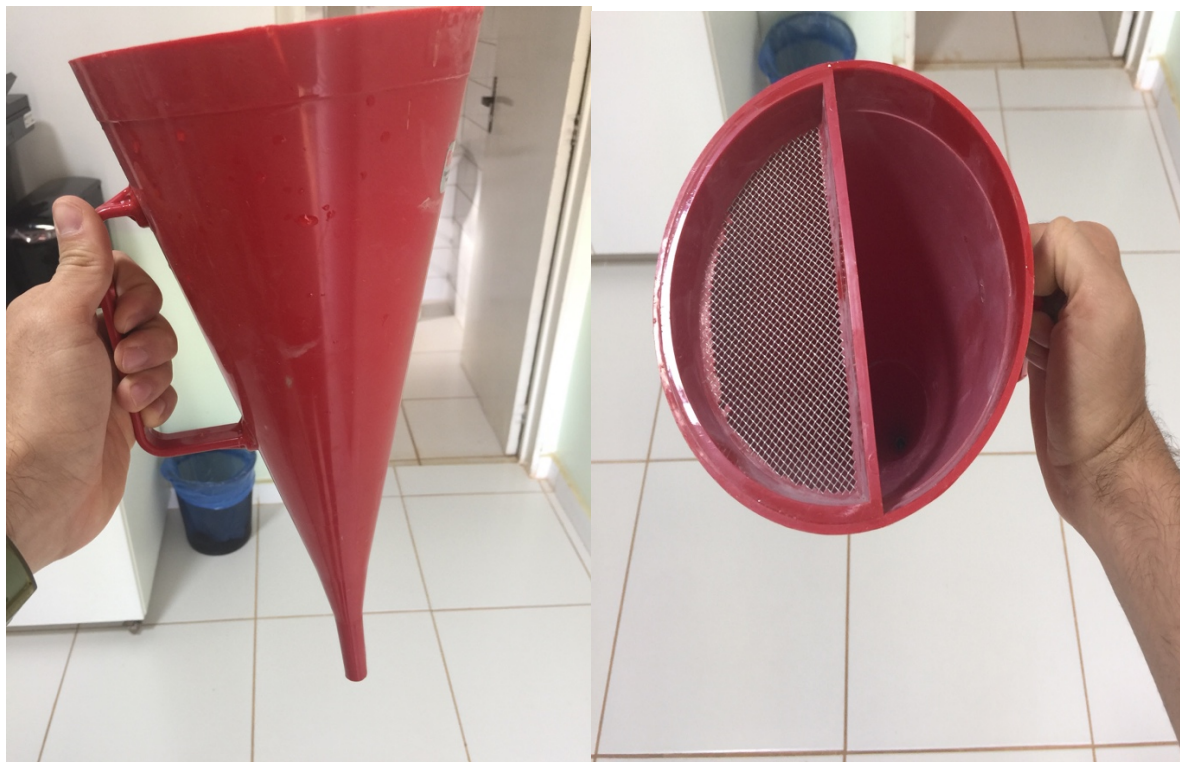
Figura 5.15 – Funil Marsh utilizado para os testes de viscosidade da calda
