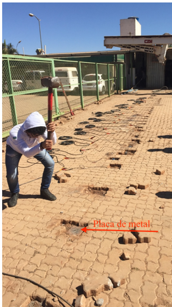
Figura 5.20 – Fonte emissora da técnica MASW. A batida do martelo na placa de metal emite um sinal que é captado pelos geofones e transferido para a aquisição de dados, que registra a diferença do tempo de chegada das ondas de cada geofone
