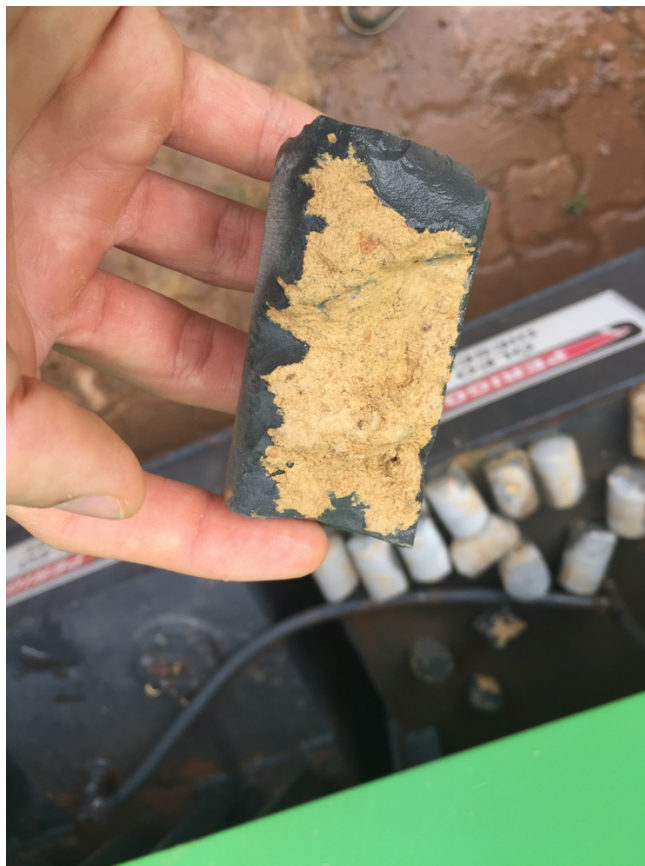
Figura 5.28 – Calda de cimento entremeada com o solo local. Somente se conseguiu retirar esta fração de solo aderida por meio do uso de torno mecânico
