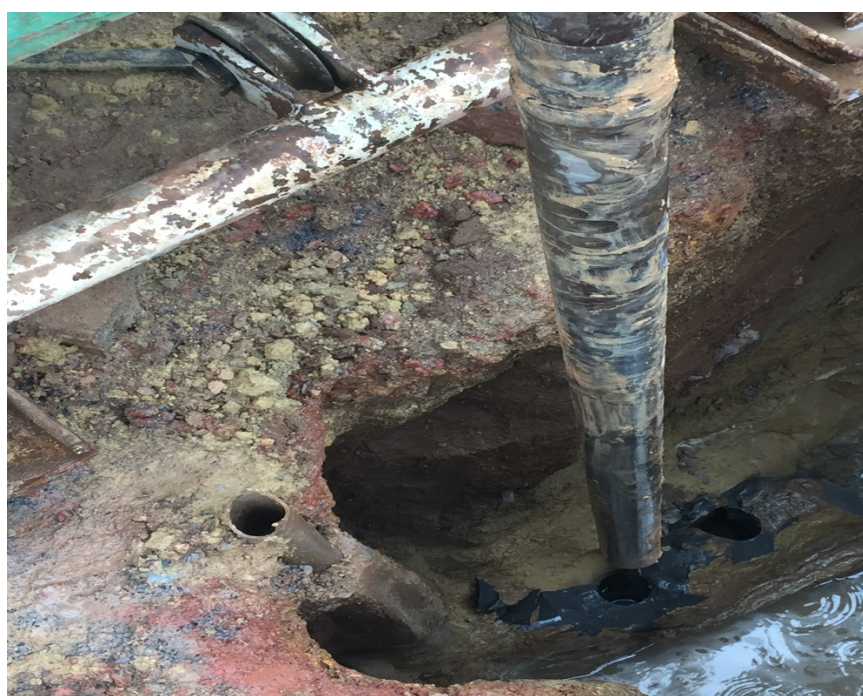
Figura 5.27 – Retirada dos corpos de prova
