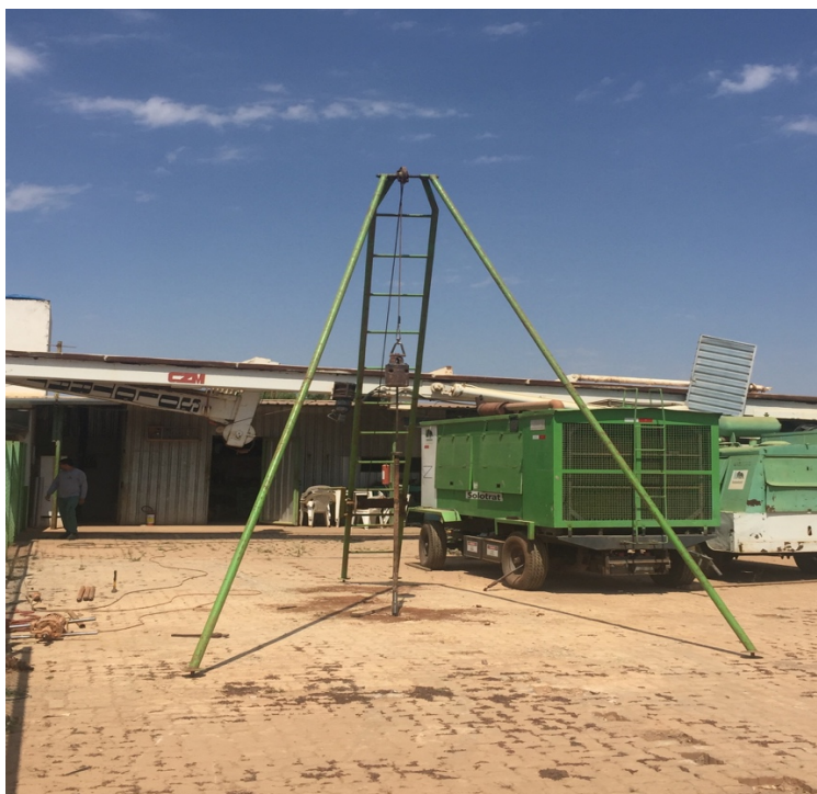
Figura 5.23 – Tripé e martelo utilizados nos ensaios SPT
