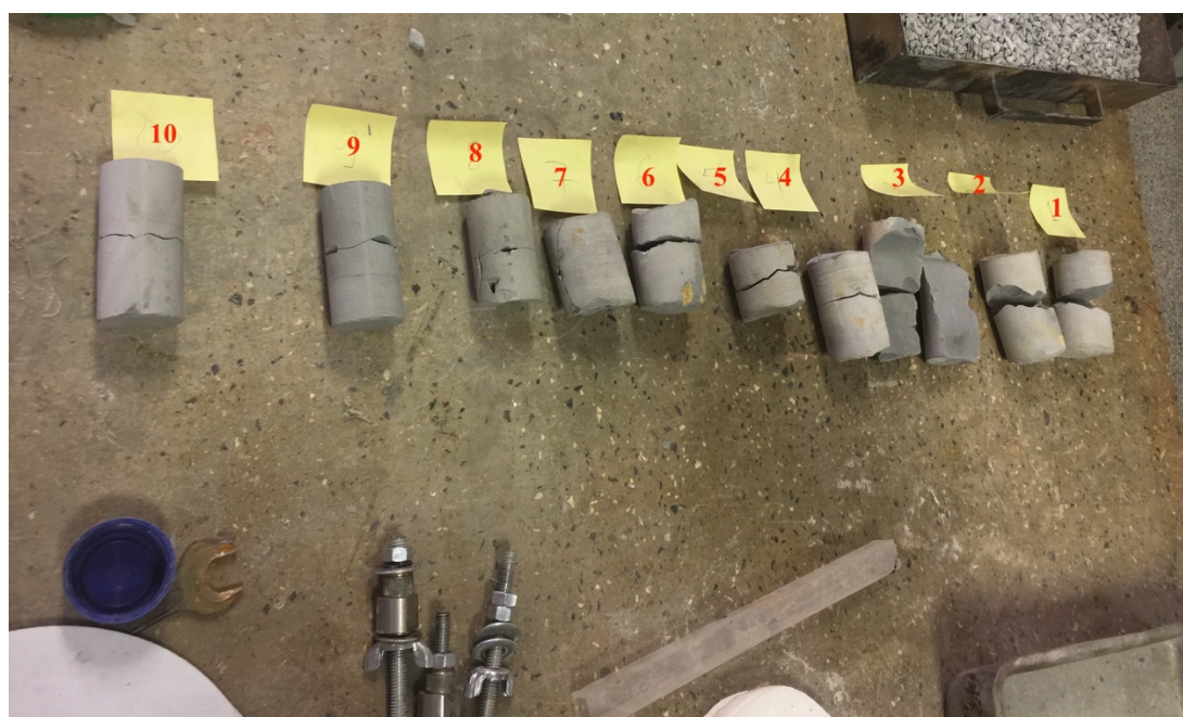
Figura 5.30 – Modos de fratura dos 10 corpos de prova requeridos para o ensaio
