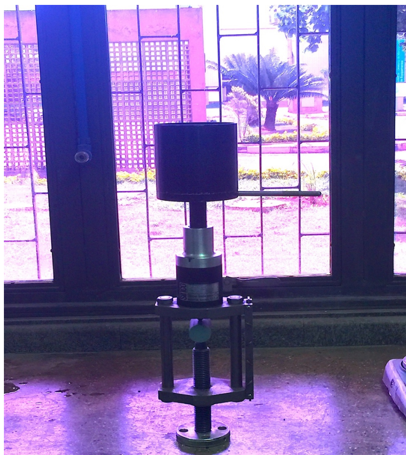
Figura 5.29 – Posicionamento típico dos corpos de prova no equipamento utilizado para o ensaio de carga puntiforme, cujo funcionamento é descrito em Hidalgo (2002)
