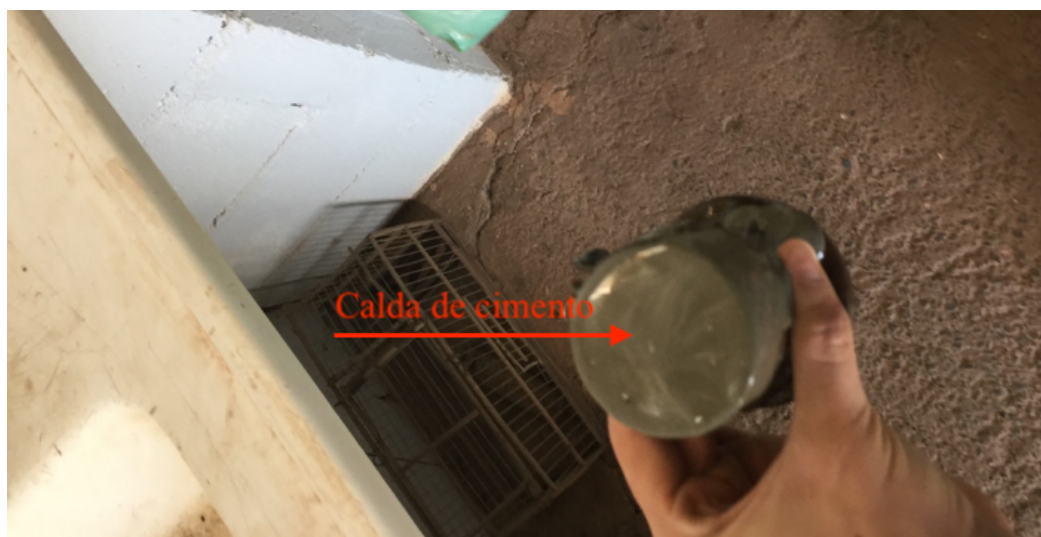
Figura 5.11 – Vista da calda moldada em corpo de prova (dimensões do corpo de prova: 50 x 100 mm)
