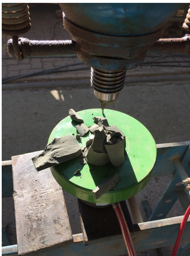
Figura 5.14 – Verificação da resistência à compressão da bainha após 12h, por prensa hidráulica
