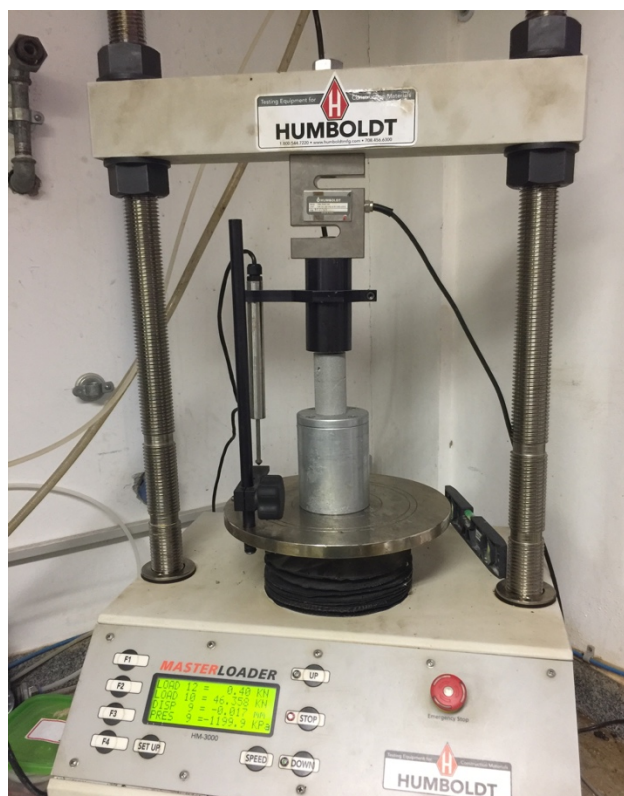
Figura 5.31 – Posicionamento típico dos corpos de prova. O equipamento de ensaio de compressão uniaxial utilizado tem seu funcionamento descrito em Humboldt (2008)
