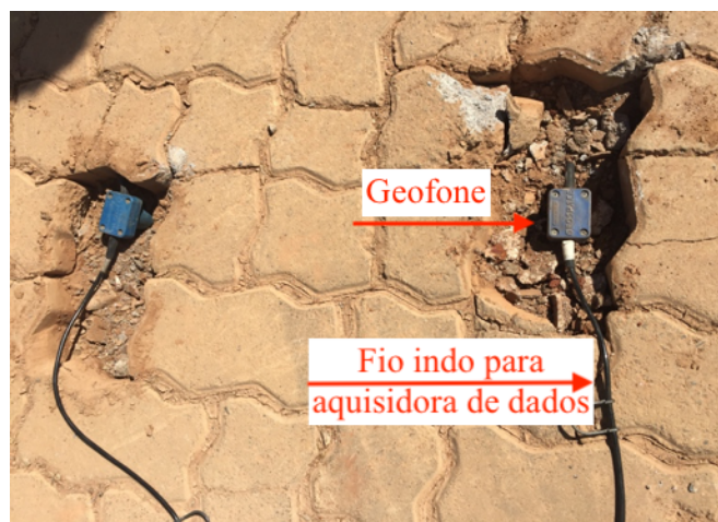
Figura 5.19 – Posicionamento dos geofones da técnica MASW, 0,5 m espaçados
