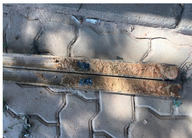
Figura 5.24 – Detalhe do amostrador utilizado nos ensaios SPT
