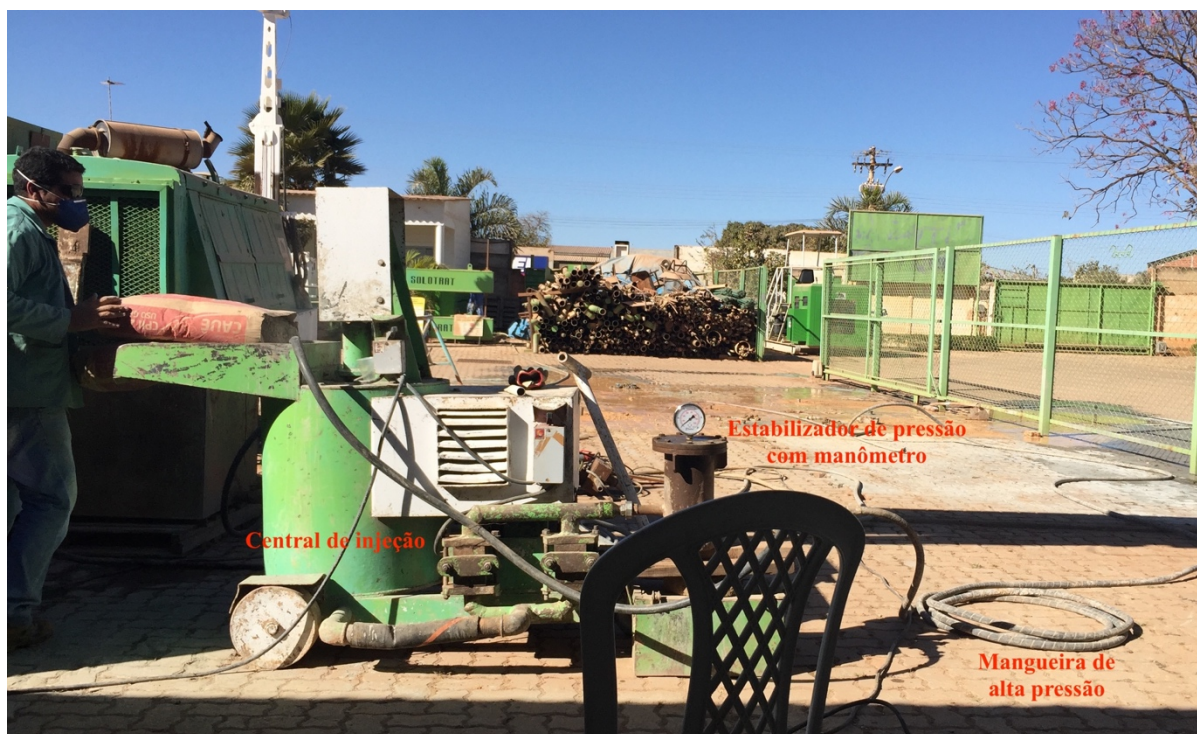
Figura 5.2 – Detalhe do equipamento utilizado para os testes preliminares
