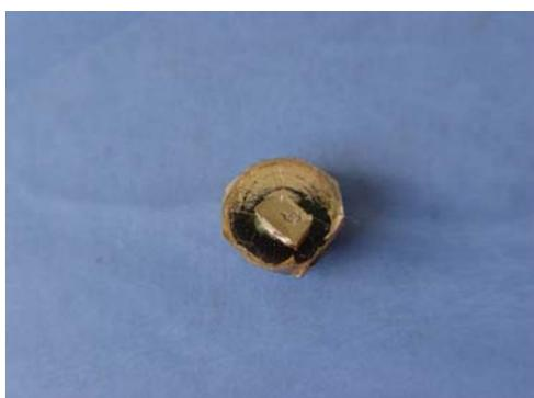
**Figura 15:** Amostra após procedimento de metalização.
