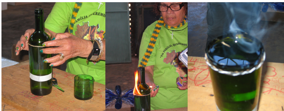
Figura 60 – Corte rústico de garrafas utilizando técnica do barbante – Sousa, 2006
