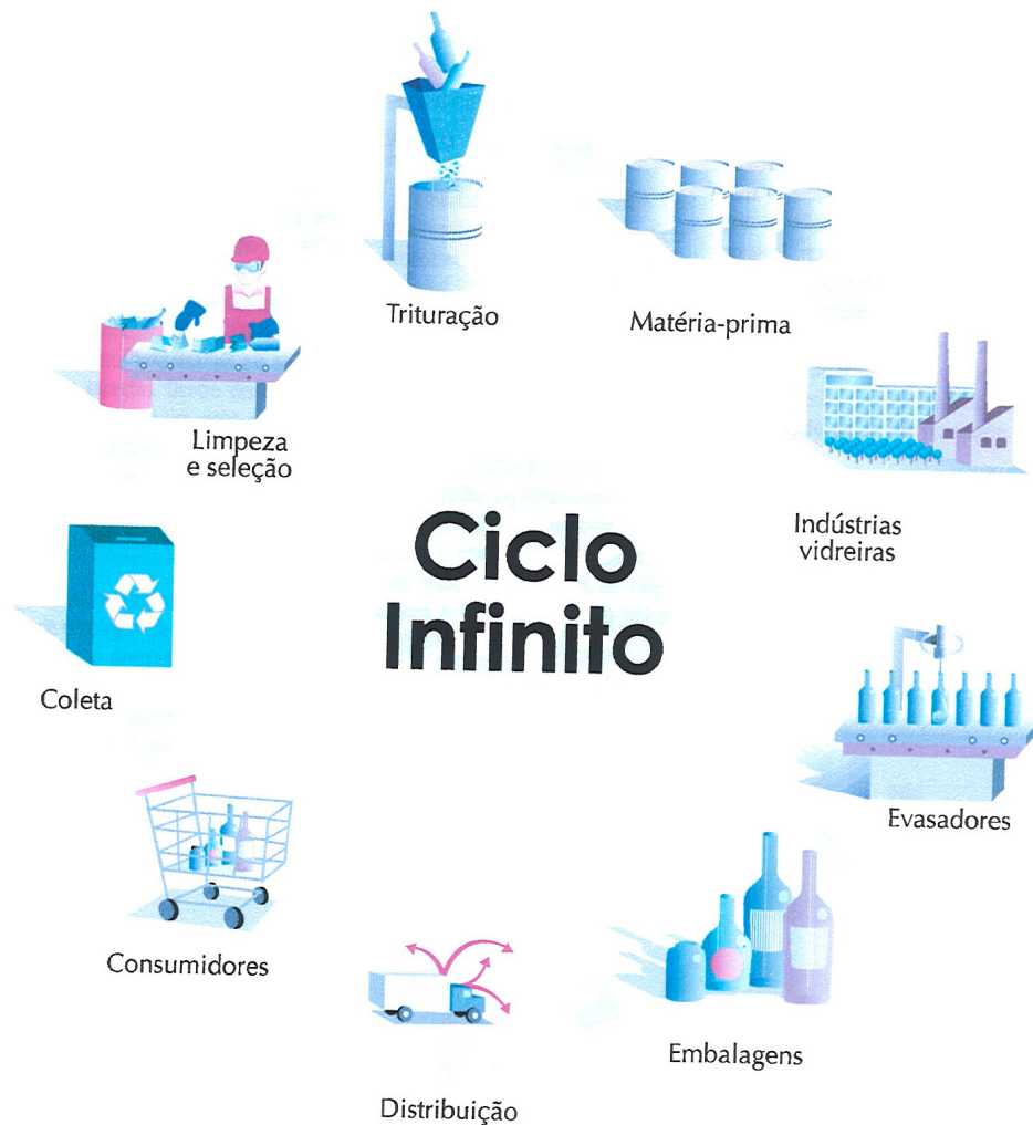
Figura 24 – Ciclo infinito – níveis da cadeia produtiva da reciclagem industrial de vidro. Fonte: ABIVIDRO, 2004.
