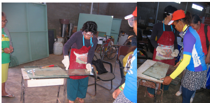
Figura 59 – Corte de vidro plano com diamante – Adriana e Anastácia, 2006
