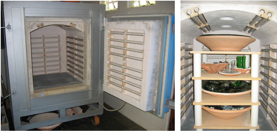
Figura 11 – Forno revestido com tijolos de cerâmica e montagem das peças nas prateleiras. Fonte: Adriana Villela, arquivo da pesquisadora, 2004.
