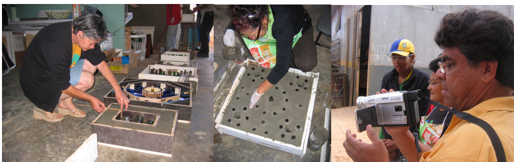
Figura 68 – Concretagem dos blocos, Carmem, Ciomara, Anastácia e Vonaldo, 2006
