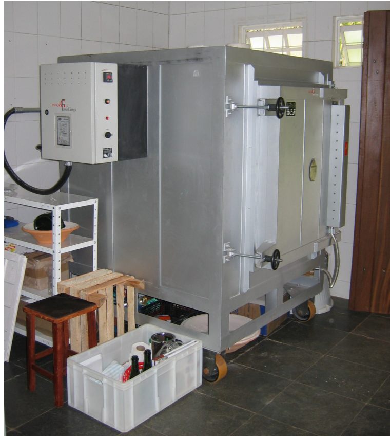
Figura 12 – Forno elétrico para fusing de vidro com abertura frontal. Fonte: Adriana Villela, arquivo da pesquisadora, 2004.
