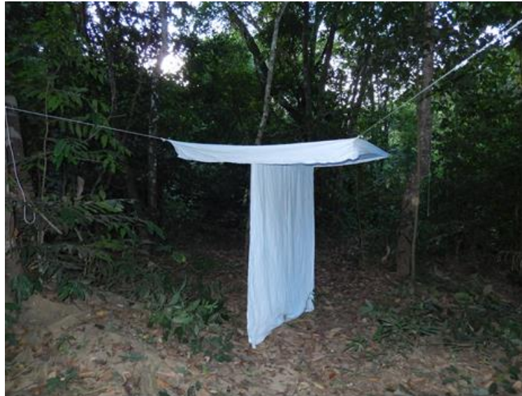
Figura 6 – Armadilha de Shannon instalada em área de mata para captura de flebotomíneos, na RA da Fercal/DF.
