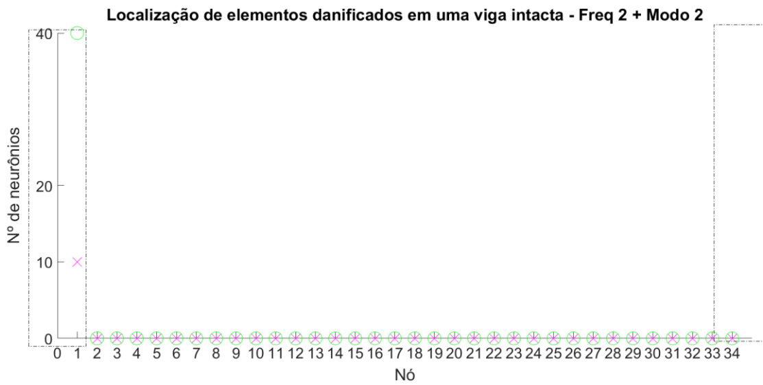
A1 2Localização de dano em uma viga intacta. (Modos e frequências 1 e 2 como dados de entrada).
