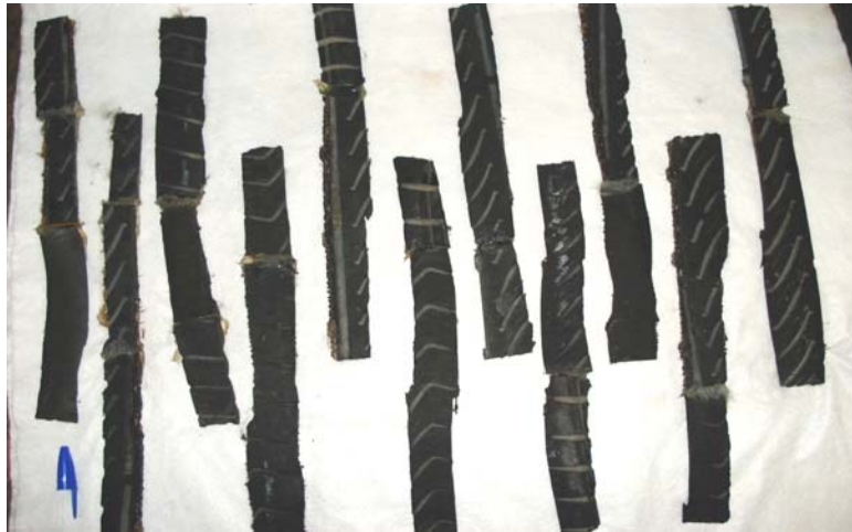
Figura 3.8 – Tiras de pneus utilizadas na formação do núcleo drenante dos geocompostos denominados GCP.
