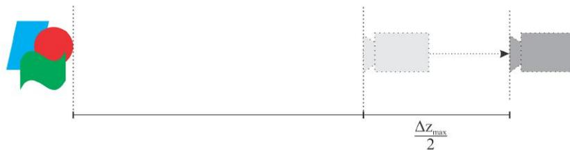
Figura 4.3: Visão lateral da câmera  $v_0$  (vista de referência) deslocada para direita (*zoom-out* para a vista virtual  $v_r$ )
