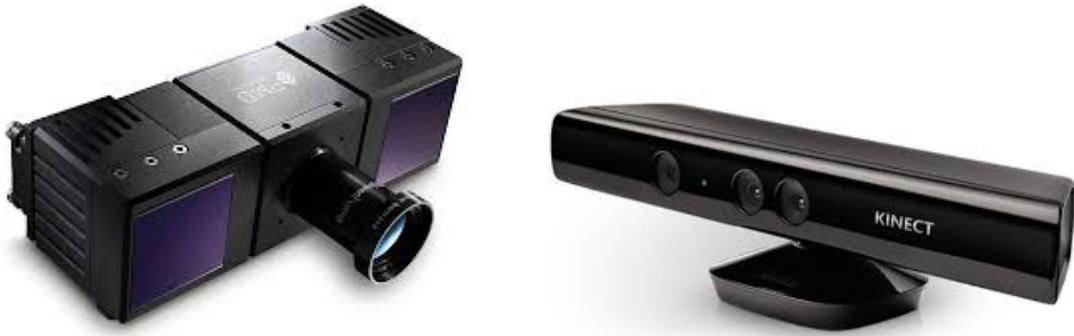
Figura 2.5: Dois tipos de equipamentos para obtenção de profundidade da cena. ToF (*Time-of-flight*) e o *Microsoft Kinect*
