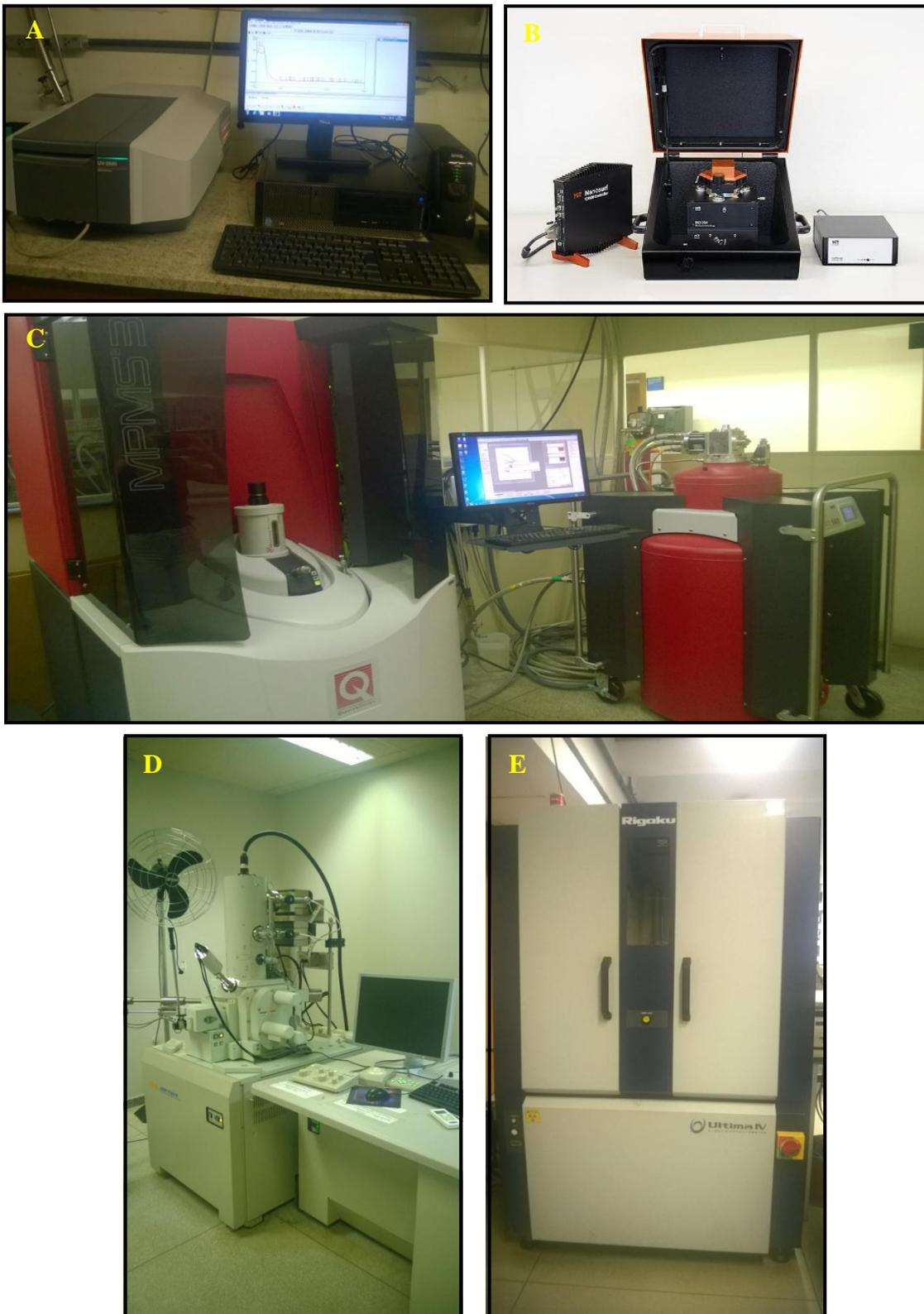
**Figura 16:** Laboratórios para a caracterização estrutural e magnética dos filmes finos: (A) Espectrofotômetro no Ultravioleta-Visível; (B) Microscópio de Força Atômica (foto comercial disponível no site da empresa responsável); (C) Sistema de Medição de Propriedades Magnéticas; (D) Microscópio Eletrônico de Varredura; (E) Sistema de Difração de Raios-X.
