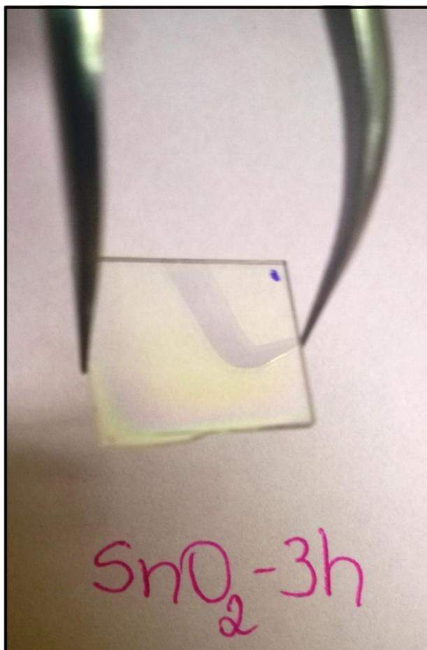
**Figura 29:** Substrato de vidro transparente, evidenciando, discretamente, cores sobre a sua superfície que representam o filme fino de SnO<sub>2</sub>, depositado pelo tempo de 3 horas.
