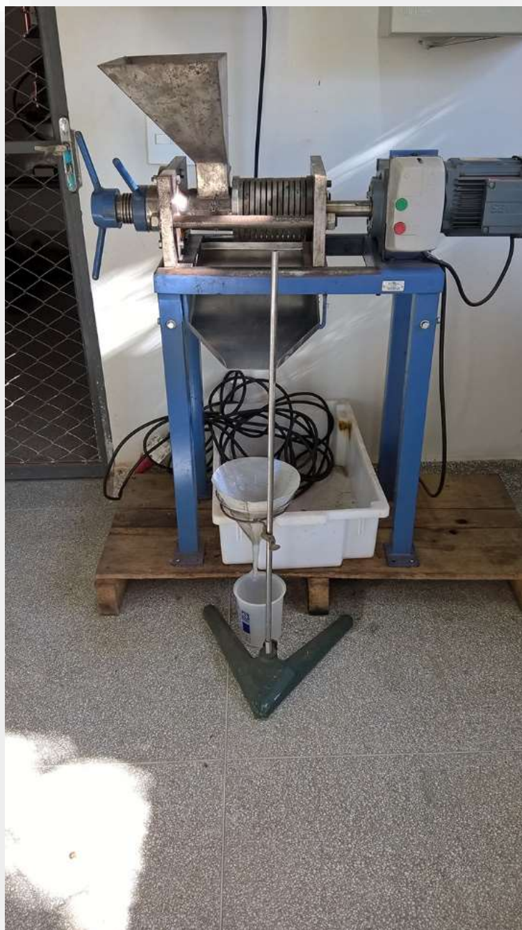
Figura 8 – Prensa hidráulica utilizada para desengordurar amostras de semente de maracujá.
