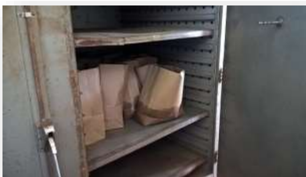
Figura 12 – Amostras acondicionadas em estufa de circulação forçada a 60°C.
