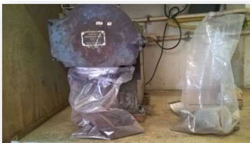
Figura 13 – Moinho utilizado para processamento das matérias-primas para obtenção das farinhas experimentais.
