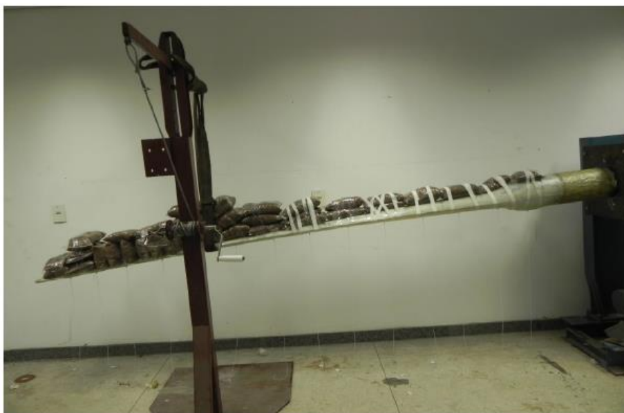
Figura 2.12 – Ensaio de flexão da pá adotado por Campos (2013). (Fonte: Campos, 2013).
