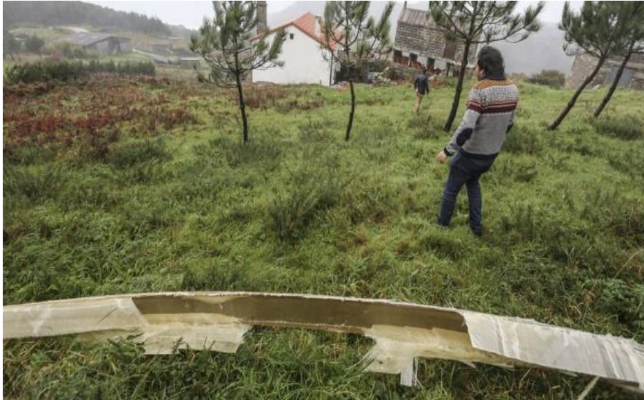
Figura 1.3 – Destroços em fibra proveniente de uma das pás do aerogerador. (Fonte: portal-energia.com).
