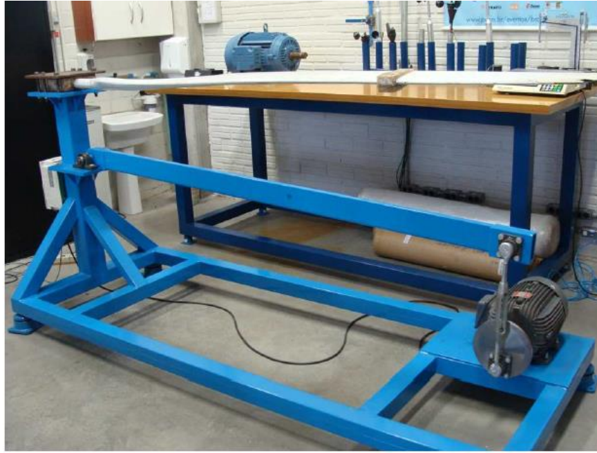
Figura 2.10 – Bancada experimental para ensaios de fadiga. (Fonte: Alé et al. , 2011).
