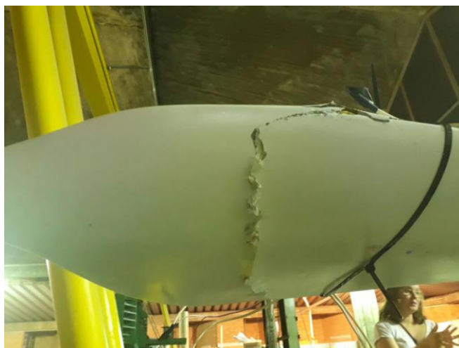
Figura 6.13 – Colapso da pá.
