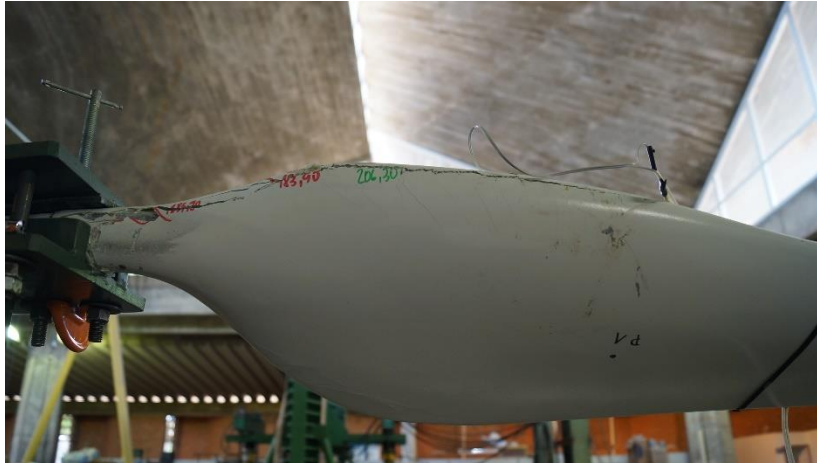
Figura 6.21 – Detalhe da fissura na borda de fuga no Ensaio 3.
