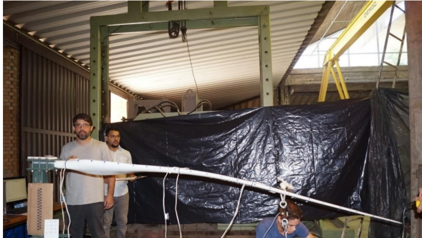
Figura 6.1 – Ensaio de flexão 1 da pá eólica com 100% da carga de projeto.
