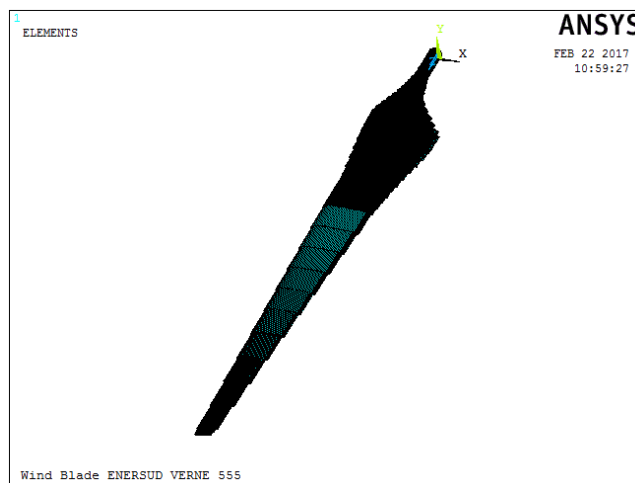
Figura 4.7 – Modelo em elementos finitos adotado.
