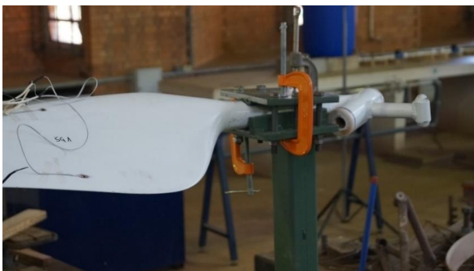
Figura 6.18 – Detalhe da inserção dos grampos no suporte.
