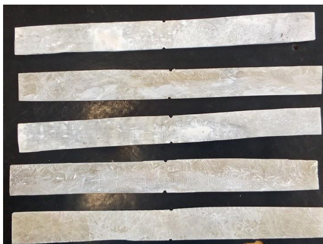
Figura 5.9 – Corpos de prova utilizados no ensaio de tração.
