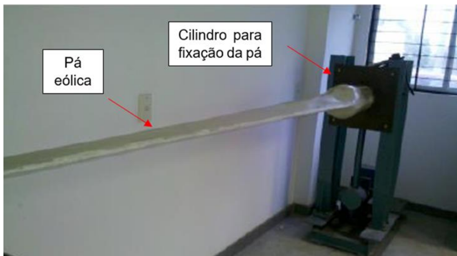
Figura 2.11 – Dispositivo para ensaios estáticos de pás de aerogeradores. (Fonte: Campos, 2013).
