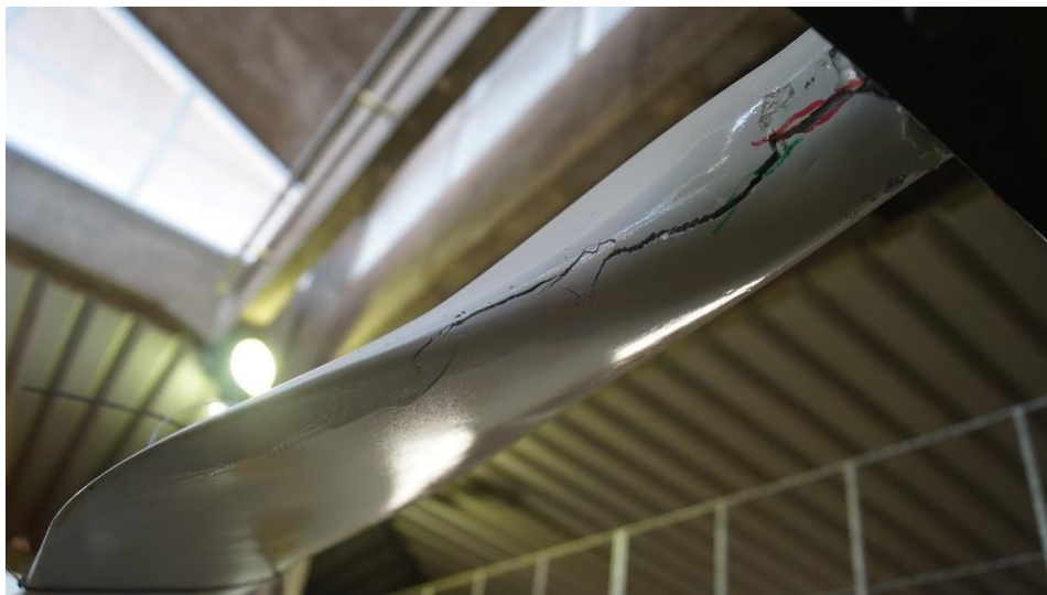
Figura 6.20 – Detalhe da fissura na borda de ataque no Ensaio 3.
