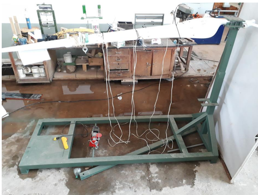
Figura 5.1 – Representação da bancada de ensaio para testes estáticos de pás eólicas.
