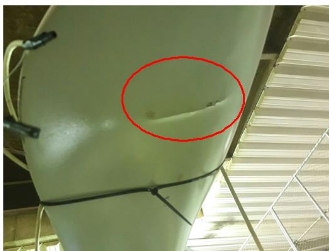
Figura 6.12 – Instabilidade da membrana da superfície comprimida da pá no Ensaio 2.
