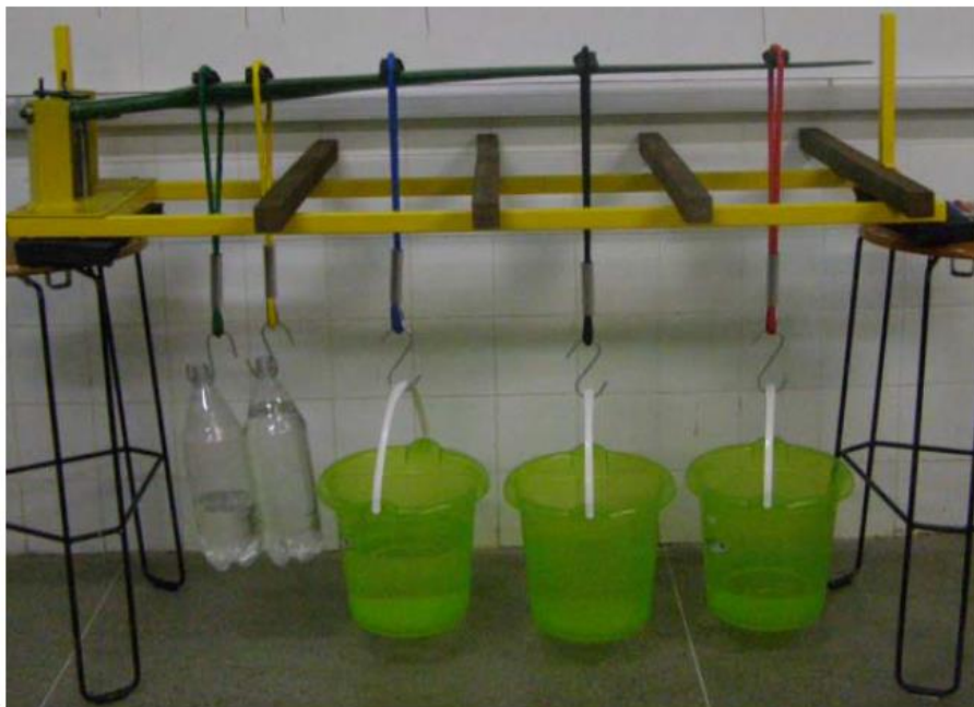
Figura 2.9 – Método adotado por Vogt (2010) na simulação de cargas aerodinâmicas. (Fonte: Vogt, 2010).
