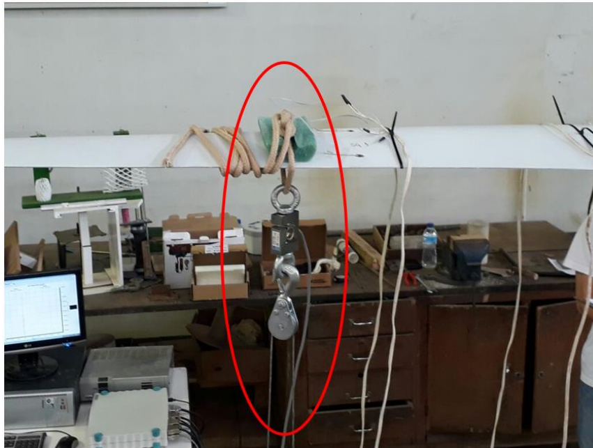
Figura 6.10 – Ligação da polia de aplicação da força na pá.
