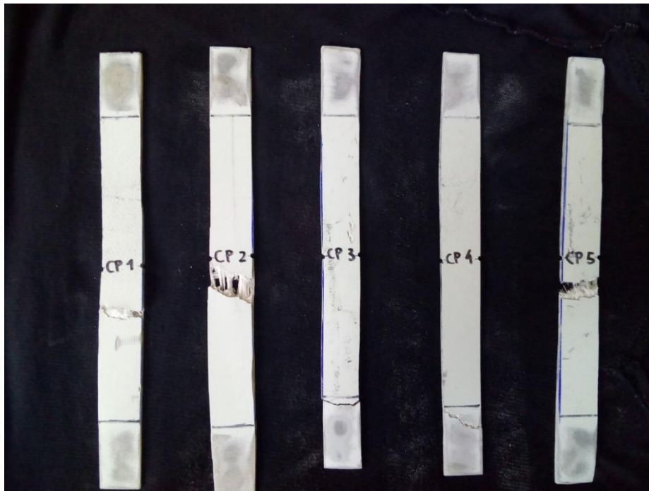
Figura 6.27 – Região de ruptura dos CP's.
