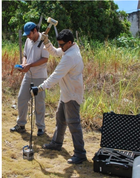
Figura 3.9 - Ensaio com o PANDA, tabuleiro costeiro Foto: Romano, M. (2015). Execução do ensaio do PANDA, maio de 2015
