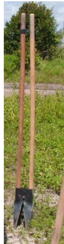
Figura 3.7 - Cavador articulado manual
