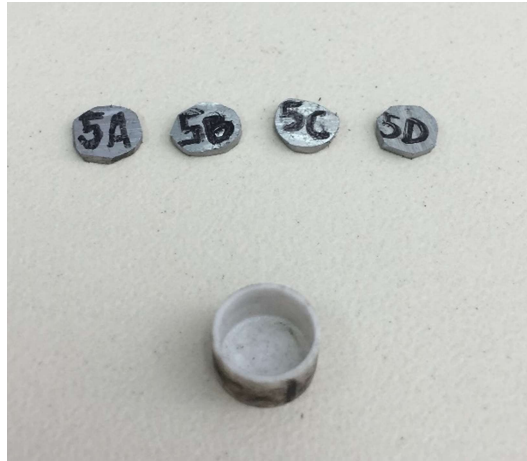
Figura 27 - Corpos de prova para realização da análise térmica por DSC e porta amostra.
