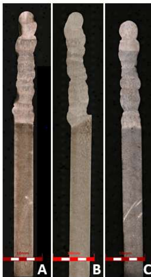
Figura 28 - Amostras do material de base CA6NM soldado com material de adição AWS 5.22 EC410NiMo nas condições de temperatura de preaquecimento em (A) 100°C, (B) 150°C e (C) 200°C.
