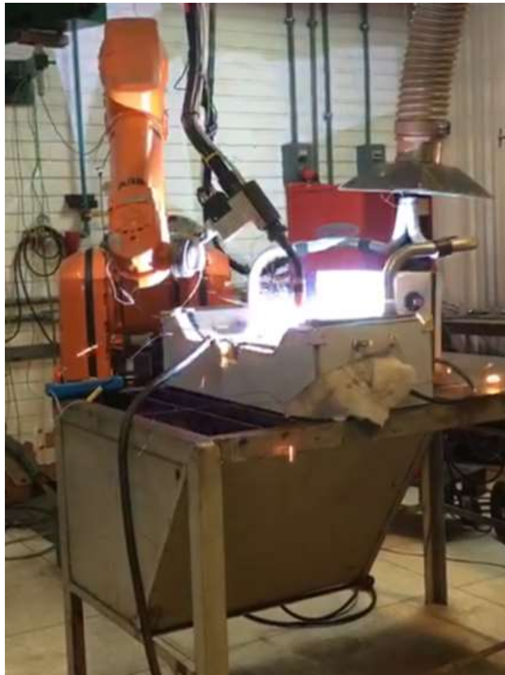
Figura 19 - Bancada de trabalho com braço robótico durante a soldagem.
