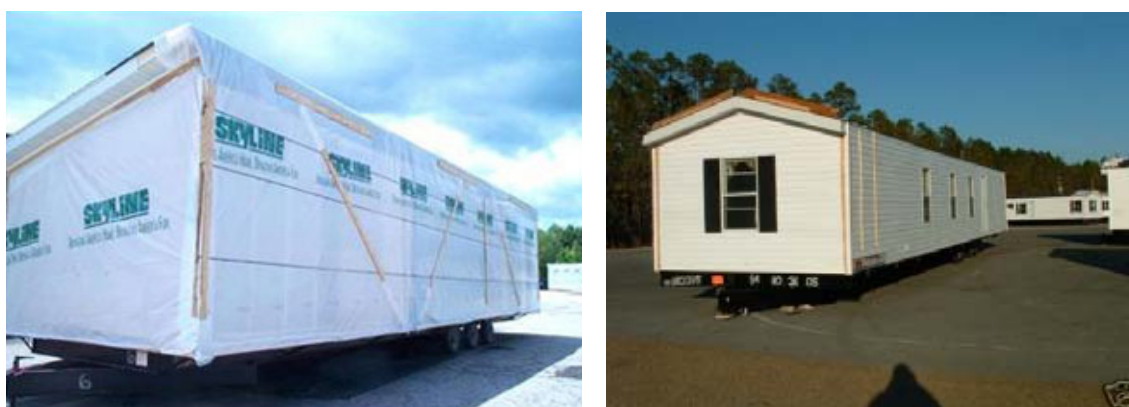
Figura 66 – Transporte com embalagem e entrega da mobile home nos EUA. Fonte: BROOKSWOODHOMES (2006).
