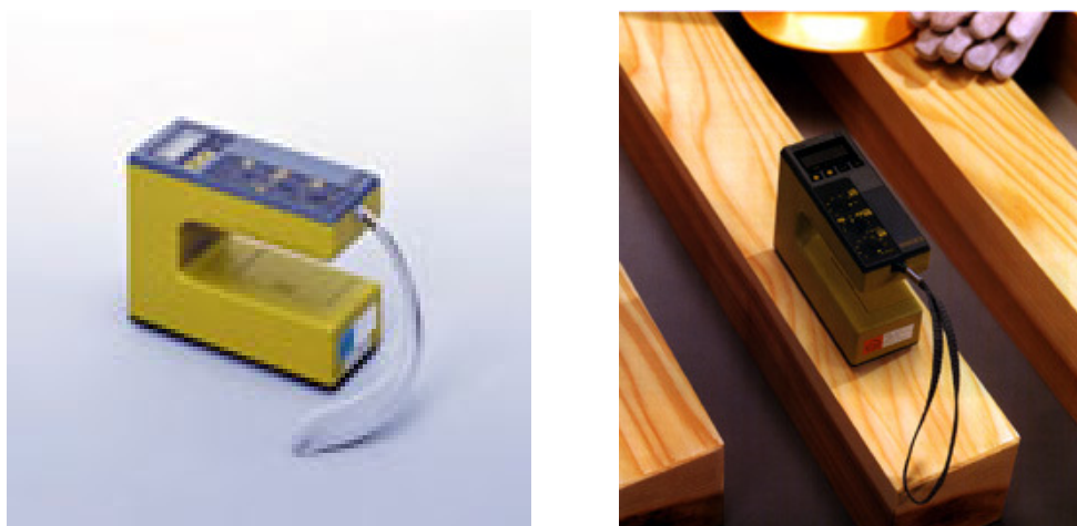
Figura 40 – Medidor de umidade portátil para madeira. Fonte: ETEC (2007).
