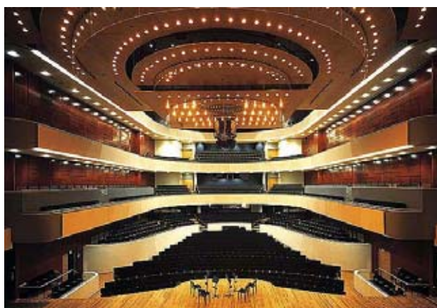
Figura 42 – Sala de concertos do Sibellius Hall, com revestimentos de balcões, paredes, pisos e teto em madeira, em Lahti, Finlândia. Fonte: ARTEC-USA (2006).
