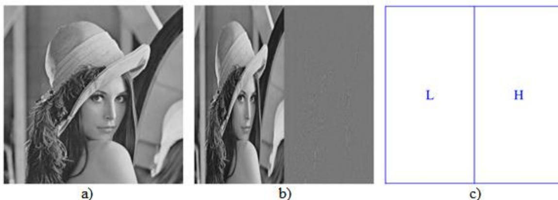
Figura 3.8 - a) Lena (512 x 512 e 8 bits de resolução). b) Saída resultante da filtragem horizontal, uma imagem composta pelos coeficientes de amostragem e detalhes. c) Ilustração da composição da imagem em b) em coeficientes de baixa (L) e alta frequência (H), respectivamente (Modificado – Ritter, 2002).
