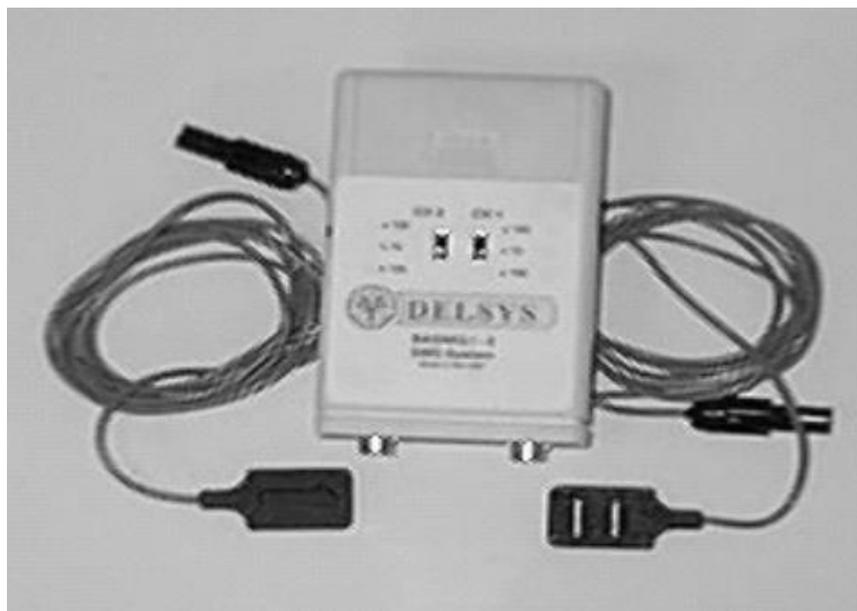
Figura 6.2 - Eletromiógrafo Delsys, modelo Bagnoli – 2 (Andrade, 2006).
