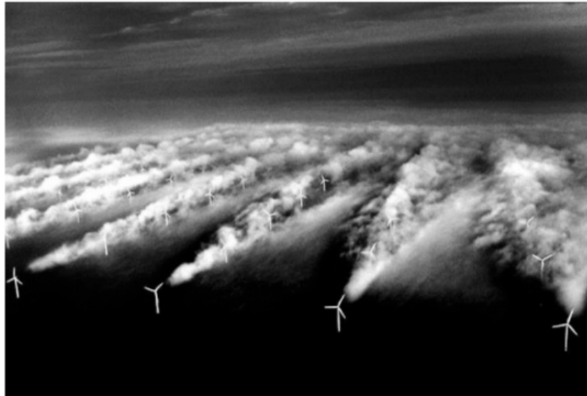
Figura 4 – Esteira turbulenta de um parque eólico. Fonte: http://www.noaanews.noaa.gov
