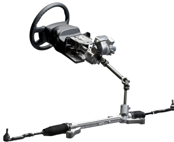
Figura 2.2: Sistema de Direção Elétrica Assitada. Fonte: Day (2013).
