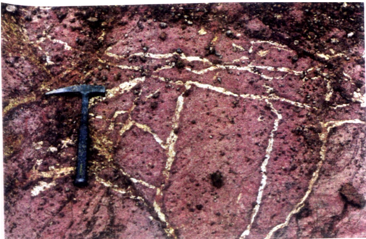
Figura 5.23 - Fraturas preenchidas por material argiloso de cor branca a branca-amarelada no saprólito fino do metargilite do Grupo Bambuí.
