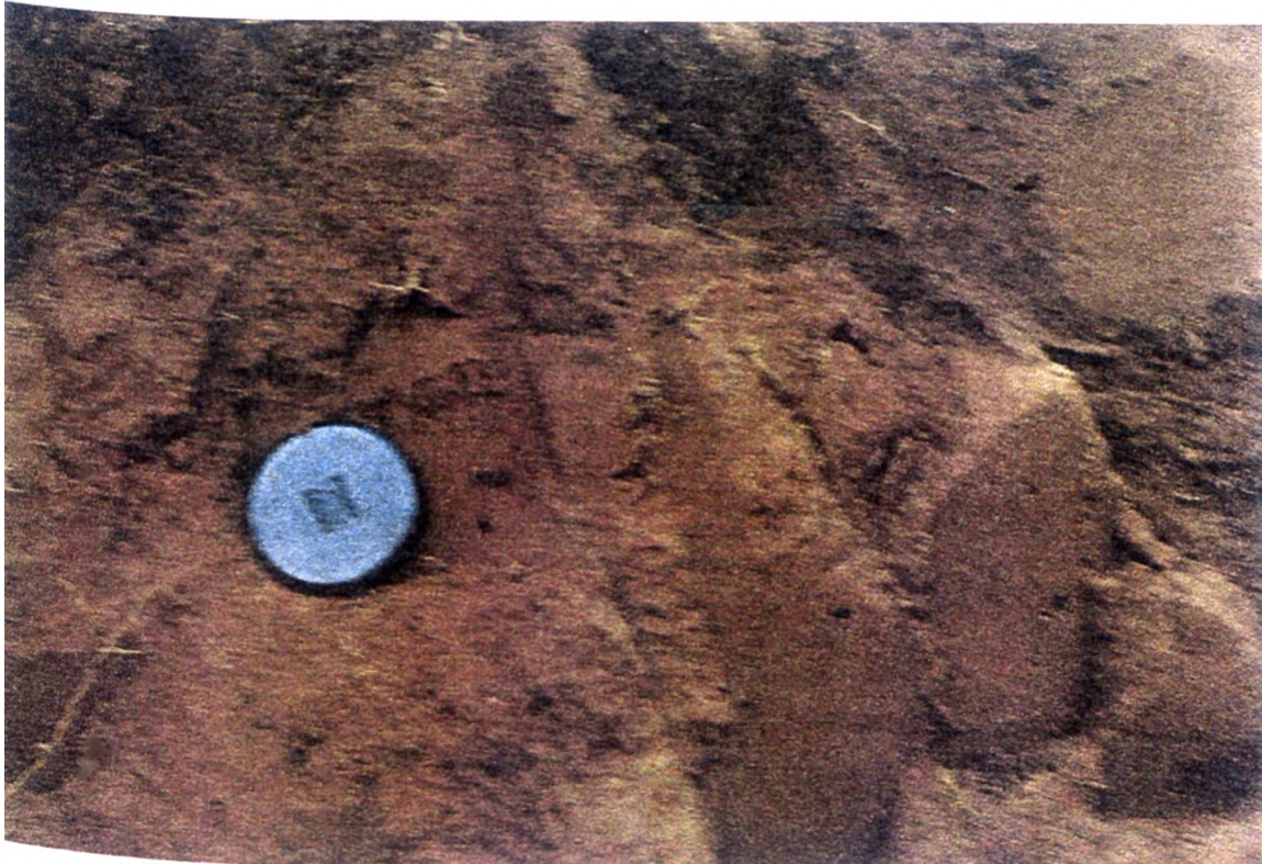
Figura 5.28 - Detalhe do saprólito fino do quartzito da Unidade Q 3 do Grupo Paranoá, onde pode-se observar a ausência de descontinuidades
