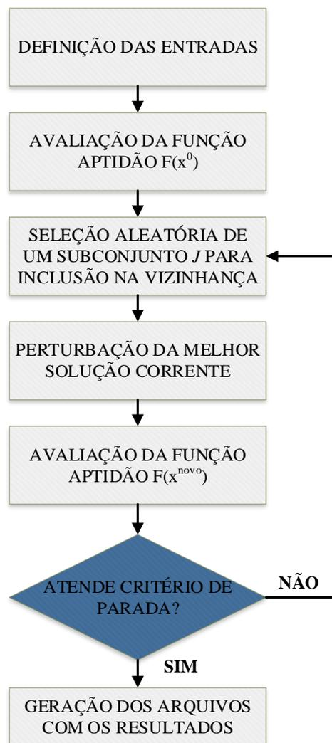
Figura 4.10 - Funcionamento do algoritmo DDS
