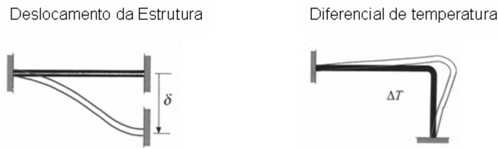
Figura 3.15 - Carregamentos que causam tensões secundárias
