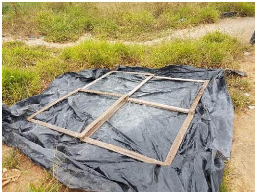
Figura D. 9 – Preparação do local para efetuar a homogeneização e quarteramento.
