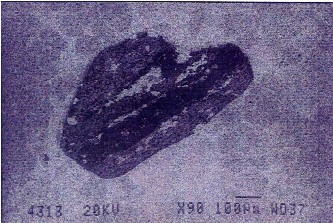
**Figura 7.5** - Fotomicrografia de um nódulo com o processo de plasmificação bastante desenvolvido. *Mud flow* (MEV).
